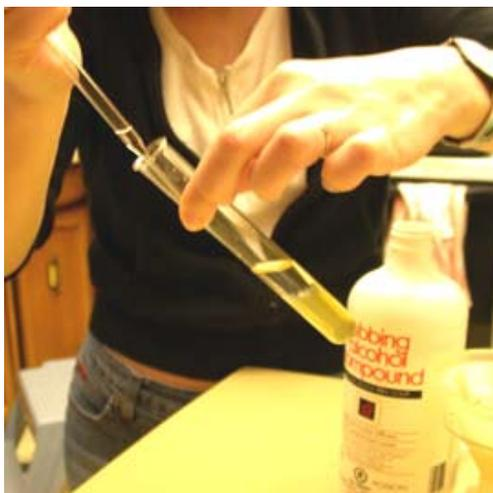
Рис. 11. Добавление этанола по краю мензурки (также может быть мерный стакан на 100 мл)
