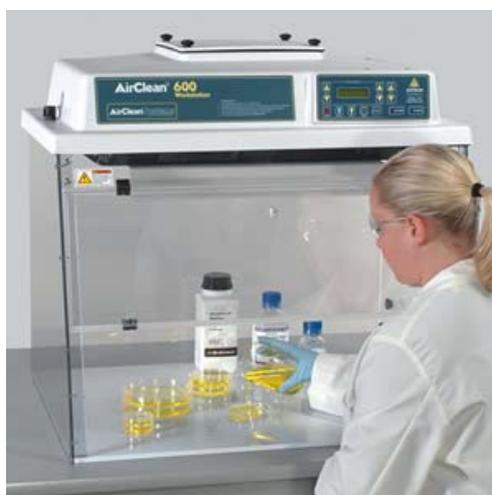
Рис. 4. Ламинарный бокс (ламинар) - приспособление для работы в стерильных условиях
