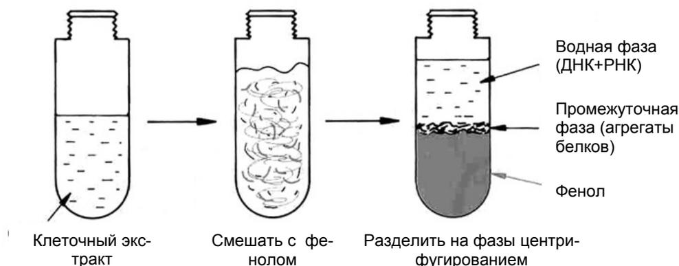
Рис. 14. Схема очищения геномной ДНК из клеточного лизата с помощью фенола
