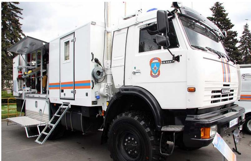
Аварийно-спасательные автомобили тяжелого типа отличаются большой полной массой (15-16 т) и соответственно большой полезной грузоподъемностью, позволяющей доставлять к месту ЧС самый разнообразный инструмент и оборудование
