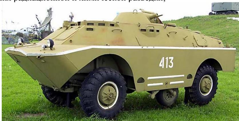
**РХМ** - разведывательная химическая машина, представляющая собой многоцелевой плавающий транспортер МТ-
