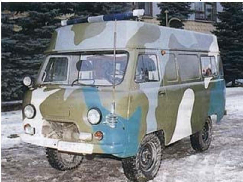
**АСМ-41-02МРР** - первая в России машина радиационной разведки и мониторинга, созданная на базе полноприводного автомобиля **УАЗ-31622** с прицепом «Тонар» модели 8310 с применением достижений российских ученых и возможностей современных средств обработки и передачи информации, предназначенная для доставки и обеспечения действий специалистов (спасателей) при проведении мониторинга объектов окружающей среды в условиях ЧС, связанных с выбросом (выливом) радиоактивных веществ.
