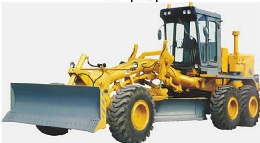
является одной из основных машин, применяемых при строительстве, ремонте и содержании дорог. С помощью автогрейдеров можно профилировать земляное полотно, возводить насыпи высотой до 0,6 м, планировать откосы, выемки и насыпи, перемещать грунт и дорожно-строительные материалы, устраивать корыта и боковые канавы в дорожном полотне, перемешивать грунт и гравийные материалы с вяжущими материалами и добавками, очищать дороги от снега.
