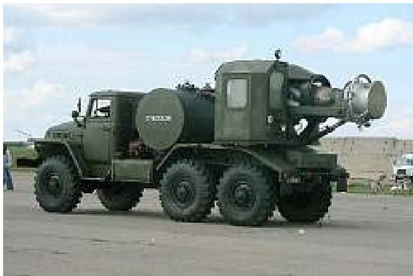
предназначена для дегазации, дезактивации и дезинфекции наружных поверхностей техники мощным газовым и газокапельным потоками. Она может быть использована также для специальной обработки участков местности, дорог с твердым покрытием и сооружений.
