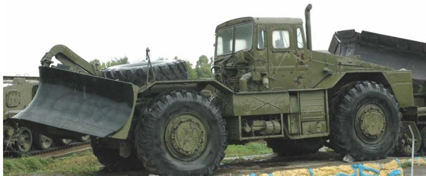
на базе ИКТ также имеет универсальный рабочий орган с гидравлическим управлением, который закреплен на кормовой части базовой машины и может занимать двухотвальное, бульдозерное и грейдерное положения. Перевод в рабочие положения осуществляется гидравлической системой из кабины. Как и БАТ-М, путепрокладчик ПКТ-2 имеет механизм перекоса рабочего органа, а также лыжу (лыжа обеспечивает копирование местности и ограничивает внедрение отвала в грунт).
