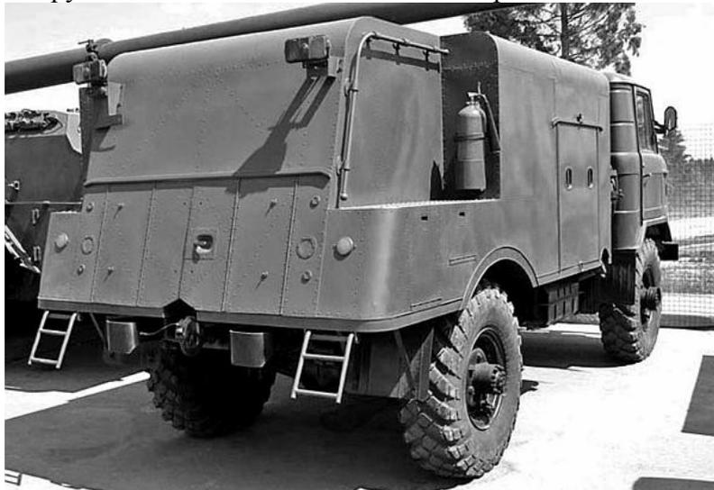
Она представляет собой автомобиль ГАЗ-66, на котором смонтировано специальное оборудование, состоящее из цистерны, двух топливных баков, дополнительной трансмиссии от двигателя, газотермического генератора, нагнетателей воздуха,
