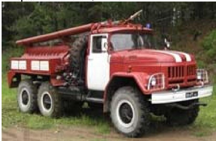
предназначена: для дегазации, дезинфекции (дезинсекции) техники; дегазации и дезинфекции местности; снаряжения растворами дегазационных комплектов; транспортировки и временного хранения жидкостей; перекачки жидкостей из одной емкости в другую, минуя цистерну; приготовления в цистерне
