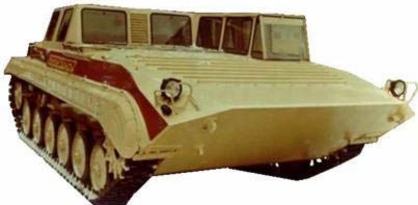
Машина предназначена для доставки специалистов и грузов в труднодоступные районы, вытаскивания застрявших транспортных средств, буксирования неисправных транспортных средств и производства электросварочных работ. Машина может
