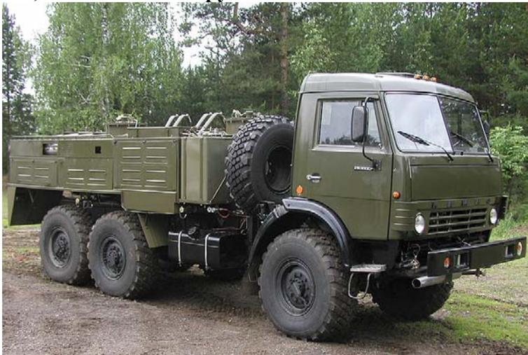
**Тепловая машина для специальной обработки ТМС-65**
