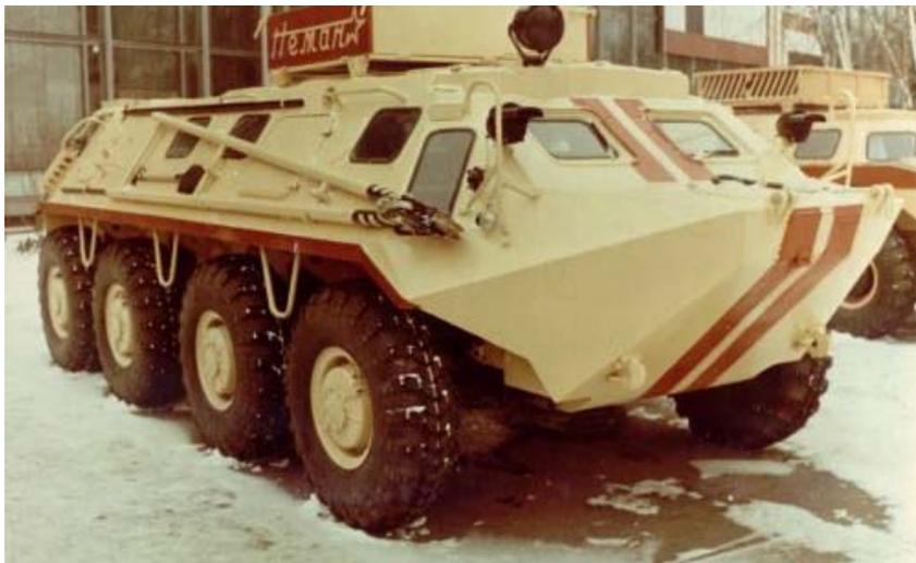
Машина предназначена для перевозки аварийной бригады и грузов в труднодоступных районах, вытаскивания застрявших автомобилей и проведения ремонтных работ, в том числе погрузочно-разгрузочных и газосварочных работ. Машина может
