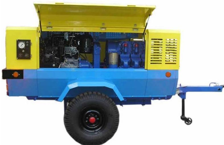
с двигателем внутреннего сгорания (передвижные поршневые ПКСД-5,25Д, передвижные винтовые ЗИФ-НВ-5М, стационарные винтовые ЗИФ-НВ -5М) используются на строительных площадках, где затруднено подключение электрической сети. Передвижная винтовая установка ЗИФ-НВ-5М оборудована двигателем Д-144-60 мощностью 44 кВт, создаёт рабочее давление 7 атм. при производительности на выходе из компрессора 1500 л/мин. Имеет габаритные размеры 385x173x180 (см) при массе 1,41 т.
