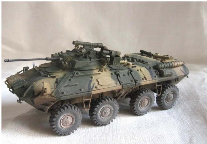
(ГАЗ-5923), разработанный в Нижнем Новгороде в начале 90-х годов и в настоящее время проходящий испытания. Опытный образец машины собран на Арзамасском машиностроительном заводе в начале 1994 года, а бронекорпус для нее был сварен в Челябинске в сентябре 1993 г. БТР-90 отличает новая компоновка и усиленное вооружение, соответствующее гусеничной боевой машины пехоты БМП-2.
