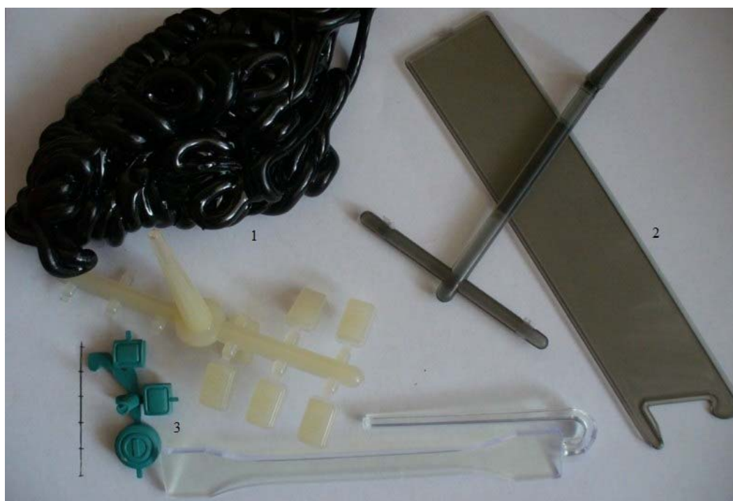
1 – остаточный материал из формы; 2,3 – остаточный материал при штамповке детали
