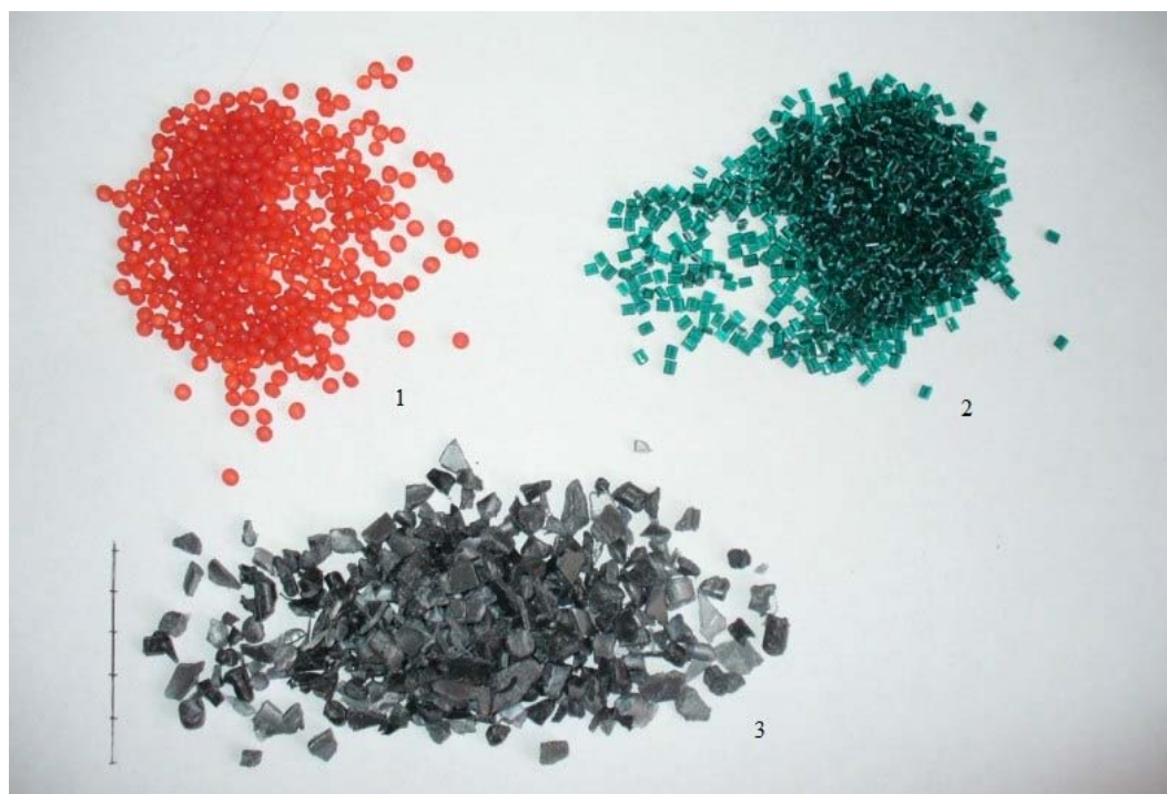
1, 2 – исходное закупаемое сырье; 3 – измельченный полимерных отходов
