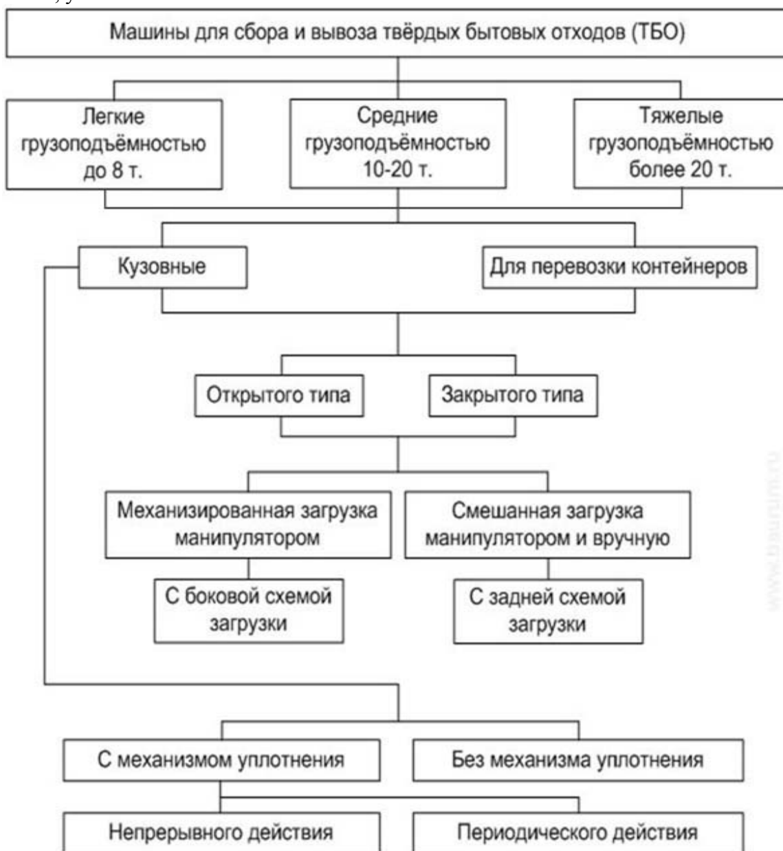
Рисунок 5 – Классификация машин для сбора и вывоза ТБО
