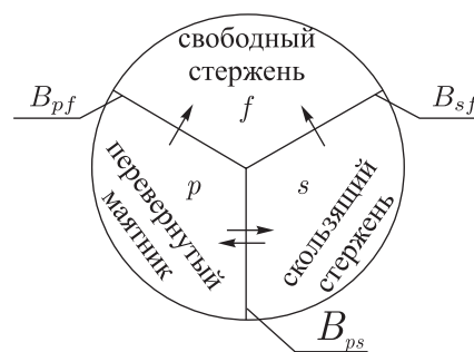
Рис. 3. Схематическое изображение возможных переходов между режимами движения, которые описываются используемыми математическими моделями.
