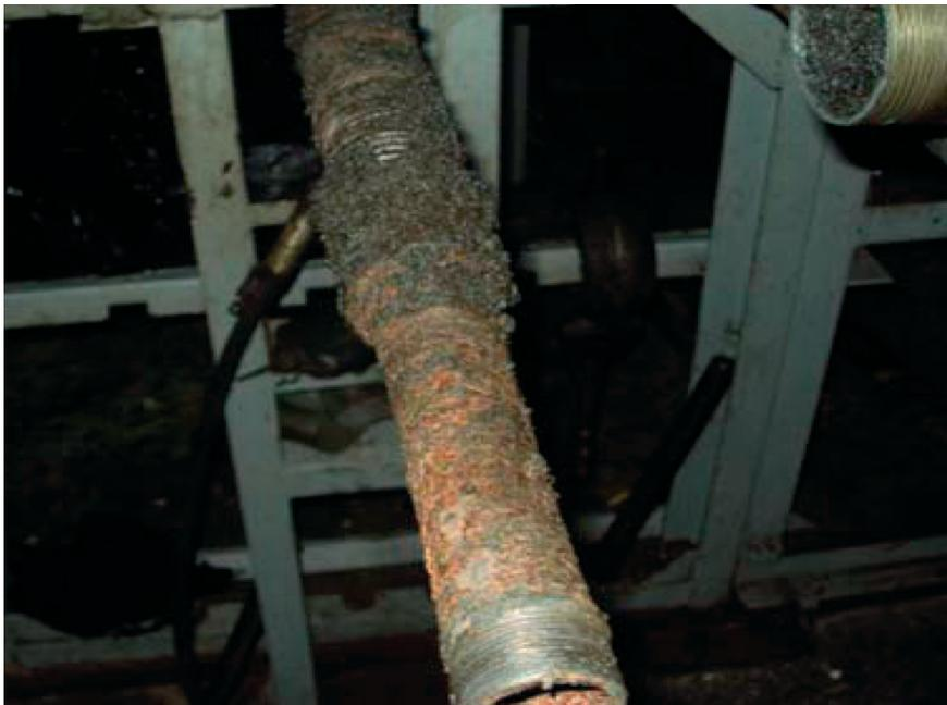
Рис. 7.18. Состояние проволочного фильтра после 150 суток работы.
