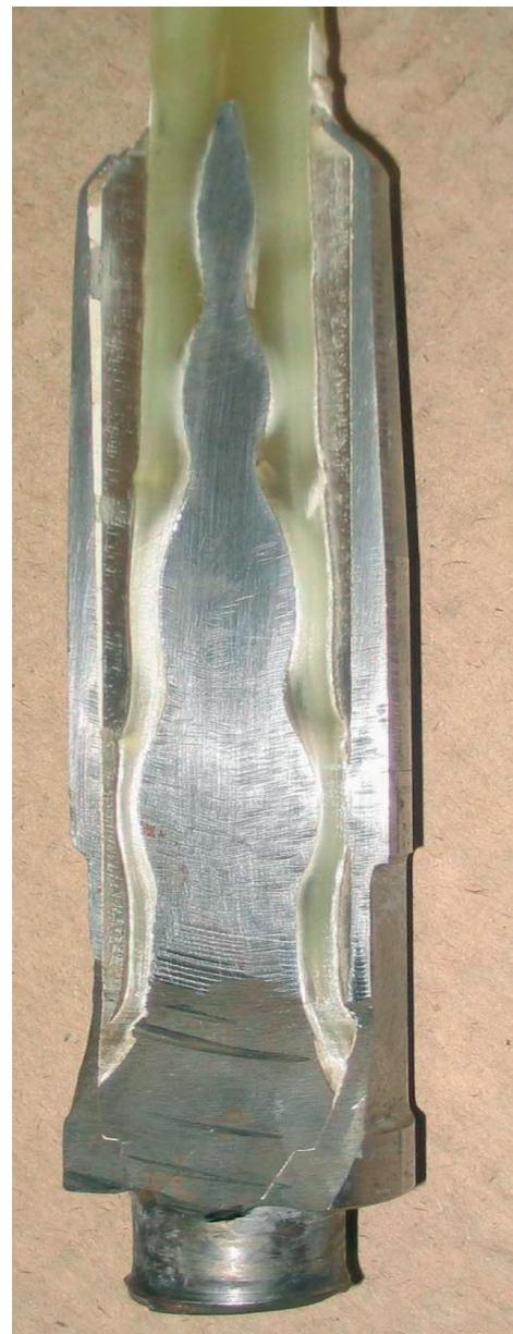
Рис. 6.11. Разрез соединения стеклопластикового стержня штанги со стальной головкой.
