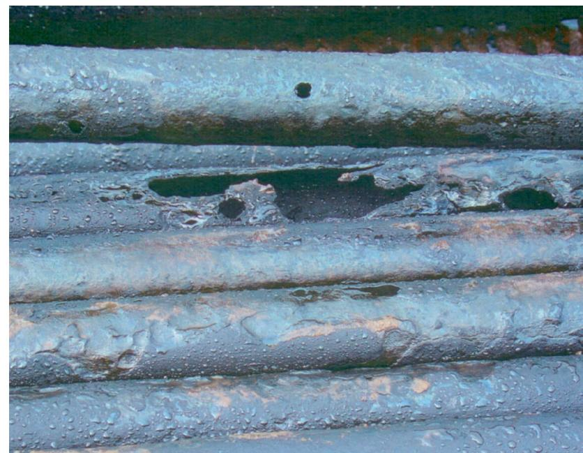
Рис. 6.2. Коррозия НКТ в нагнетательной скважине сточной воды произошла снаружи и изнутри.
