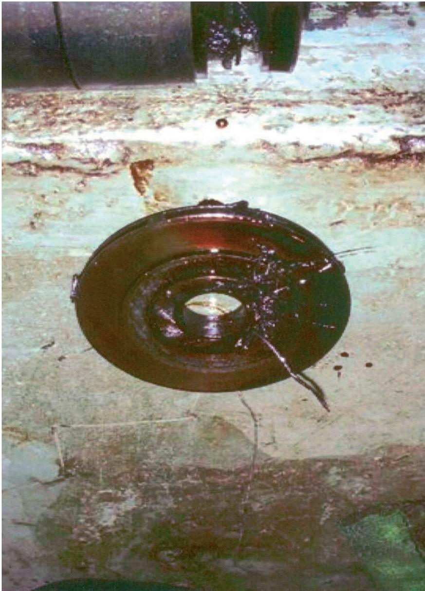
Рис. 7.6. Первые колеса ЭЦН забиты поверхностным хламом (в данном случае – полиэтилен).
