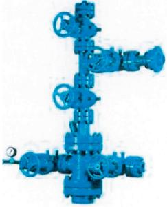
Предназначена для герметизации устья нагнетательных скважин, обеспечения возможности подвески колонны насосно-компрессорных труб, регулирования и контроля режима зачки раствора в скважину, установки и присоединения специальных технологических и измерительных устройств.
