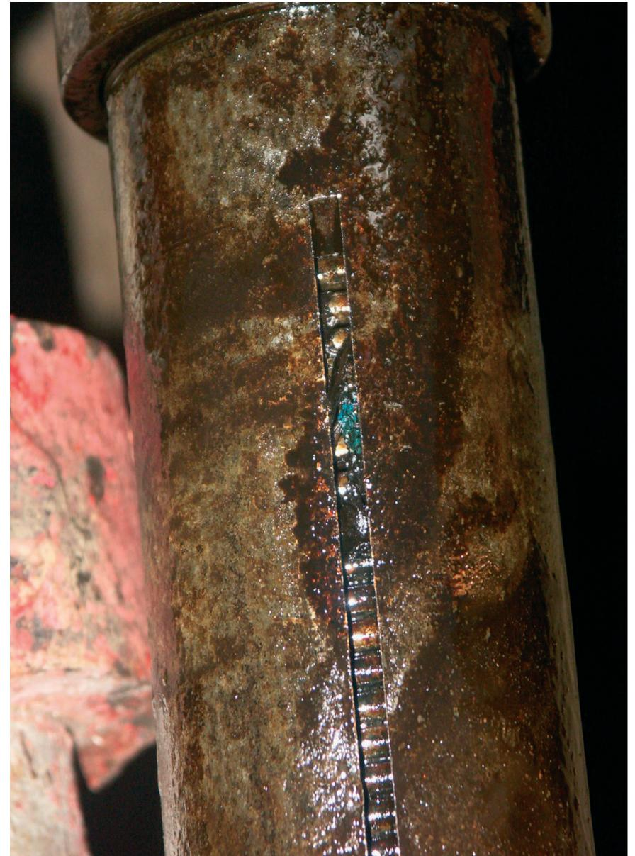
Рис. 7.9. Фильтр СШНУ марки ФРНП местами забит поверхностным мусором.
