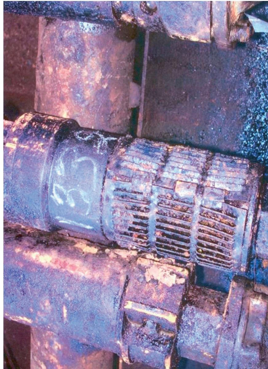
Рис. 7.7. Приемная сетка ЭЦН забита мехпримесью крупных размеров.
