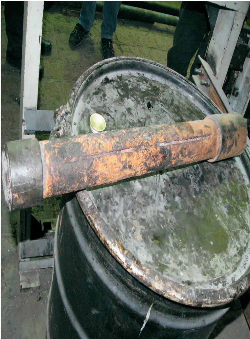
Рис. 7.16. Проволочный фильтр, поднятый со скважины. Фильтр полностью забит продуктами коррозии, солями и АСПО. Очистке и повторному использованию не подлежит.
