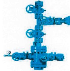
Предназначена для герметизации устья нагнетательных скважин, обеспечения возможности подвески колонны насосно-компрессорных труб, регулирования и контроля режима закачки растворов в скважину, установки и присоединения специальных технологических и измерительных устройств.
