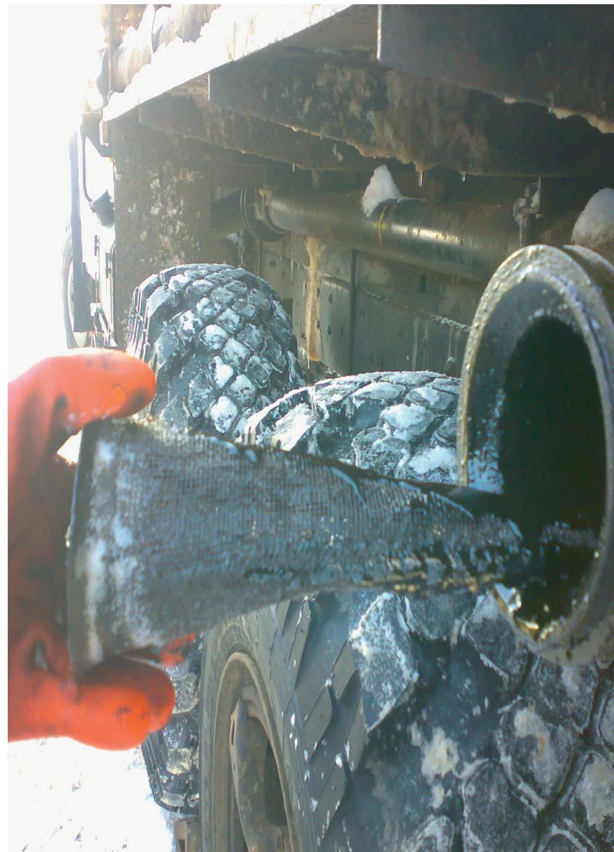
Рис. 7.12. Фильтры, применяемые на приеме ЦА-320 и АДП на Гремихинском месторождении нефти.
