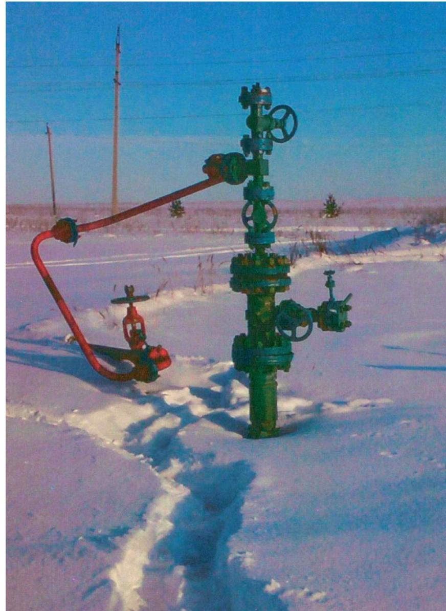
Рис. 8.3. Паронагнетательная скважина на кусте 16 Гремixinского месторождения. Нет дистанционного привода задвижек, нет термокармана.
