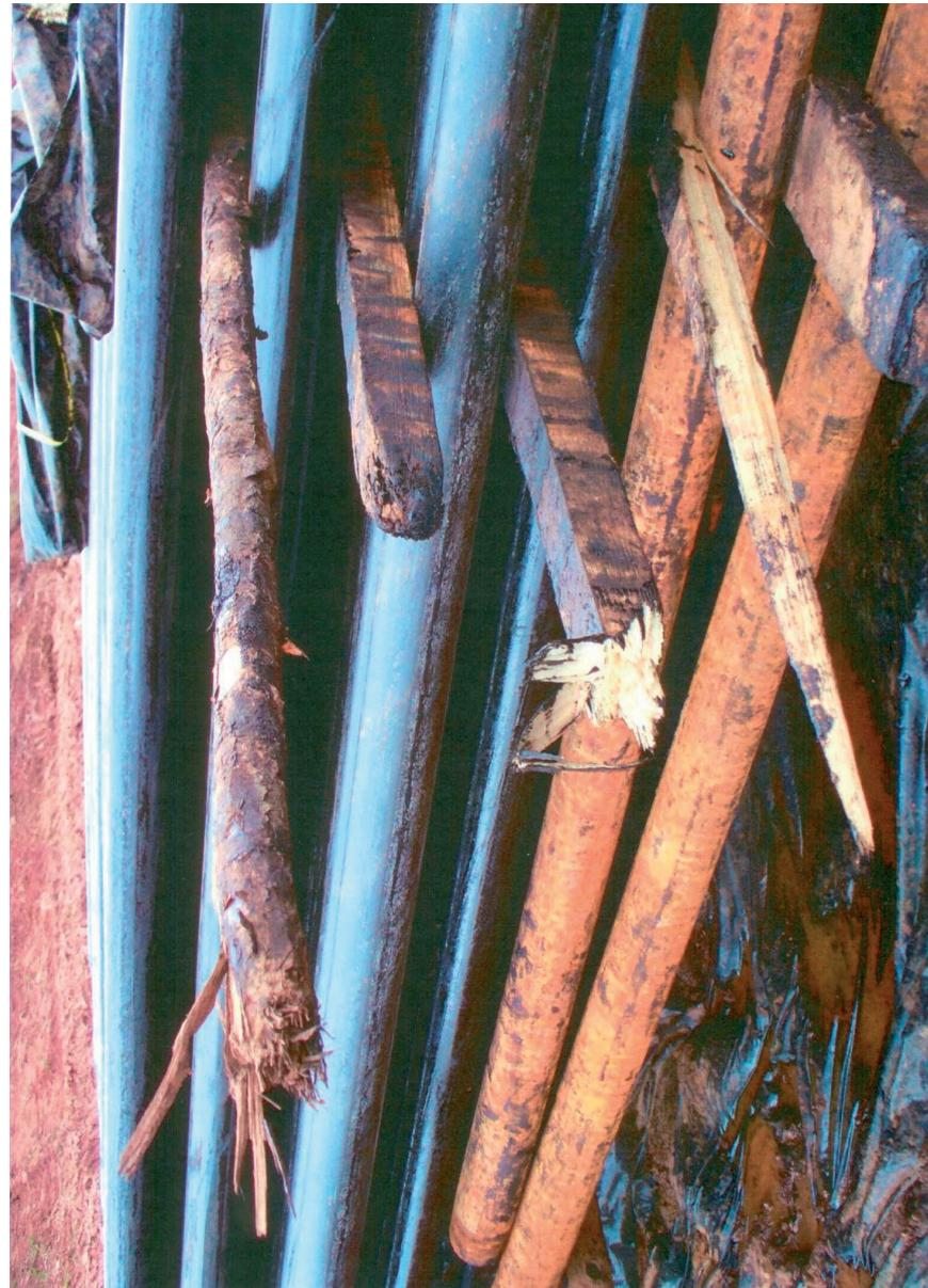
Рис. 7.3. Некачественные прокладки между НКТ - причина засорения скважин (Киенгопское м.р. скв.732.)
