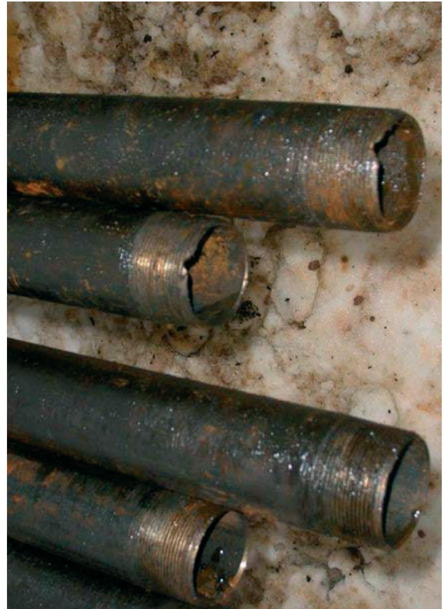
Рис. 6.9. Первоочередное разрушение НКТ происходит в резьбовой части.
