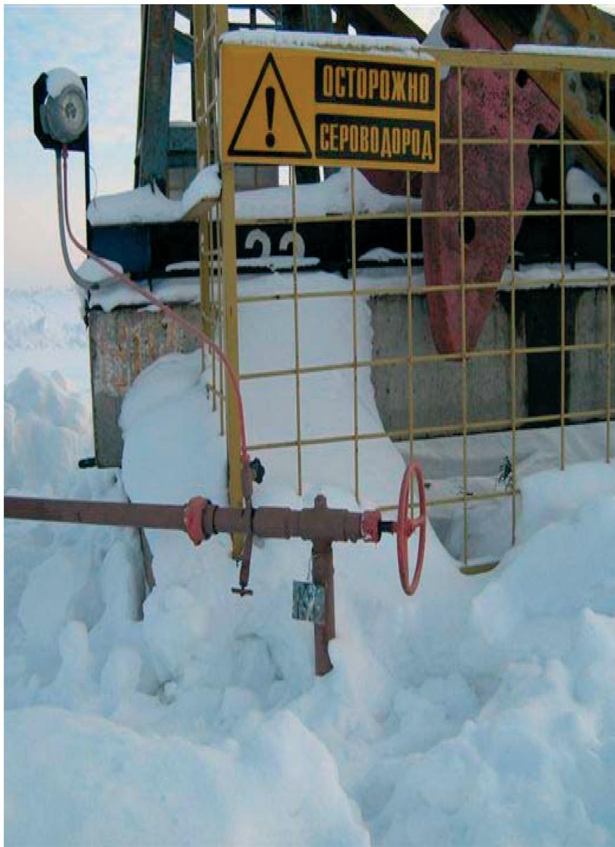
Рис. 8.6. Кырыкмасское месторождение. При ТКРС нет необходимости демонтировать ЭКМ, пробоотборник.
