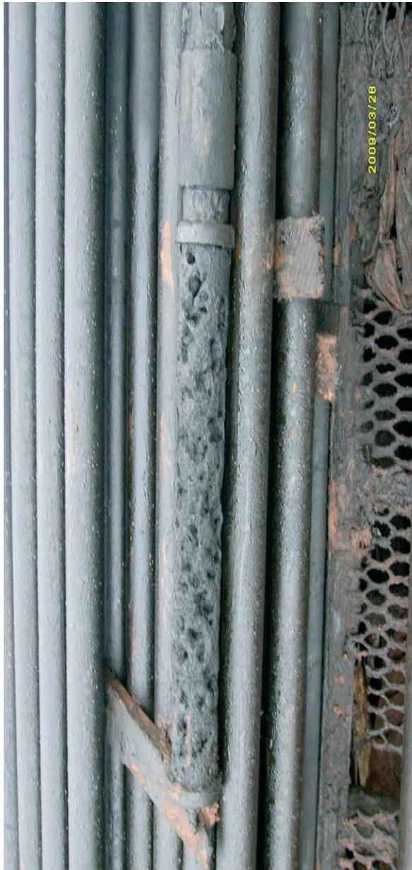
Рис. 6.13. Использованный протектор из магниевого сплава. Скв. 1919, Мишкинское м.р.
