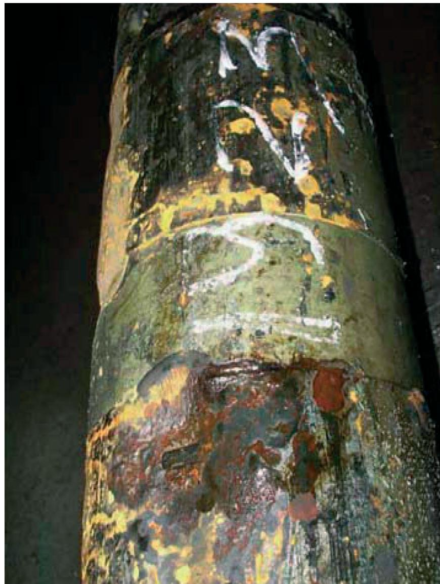
Рис. 6.3. Характер коррозионного повреждения корпуса погружного электродвигателя УЭЦН.
