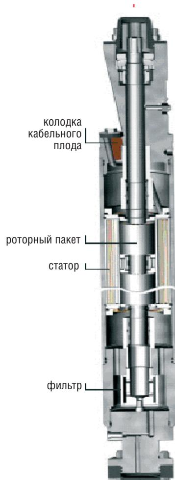
При использовании вентильного электропривода появляются дополнительные возможности для работы в зоне перфорации и ниже зоны перфорации. Упрощается технологический регламент вывода скважин на режим. Значительно увеличивается мощность двигателя в односекционном исполнении. Снижается энергопотребление. При определенных условиях эксплуатации появляется возможность замены ШГН.
