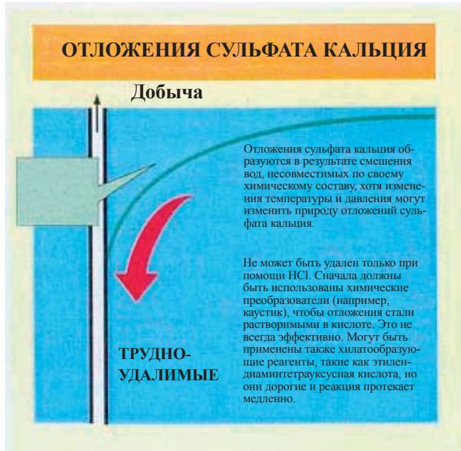
Как правило, смешивание пластовой и закачиваемой воды в нижней части обсадной колонны и НКТ приводит к образованию сульфатных отложений. Это может произойти и в пласте, но только как следствие процессов, происходящих в призабойной зоне, где уменьшение проницаемости сильно влияет на поток жидкости. Вдобавок к этому, отложения могут образовываться даже в перфорационных отверстиях.
