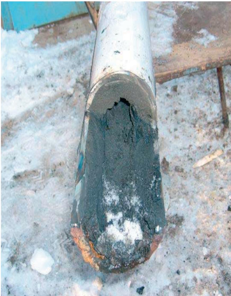
Рис. 5.1. Разрез водовода сточной воды на Мишкинском месторождении нефти с отложениями, состоящими из карбонатов, сульфатов, сульфида железа, АСПО, мехпримесей.
