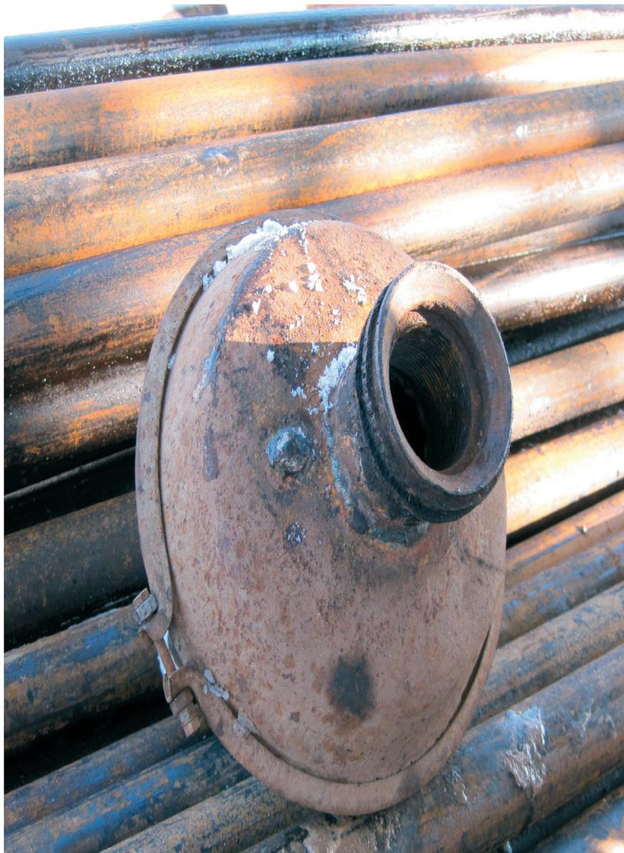
Рис. 7.11. Фильтр на приеме ЦА-320. Внутри установлена перегородка с диаметром отверстий 1,8 мм. Применяется на Киен-гопском месторождении нефти.
