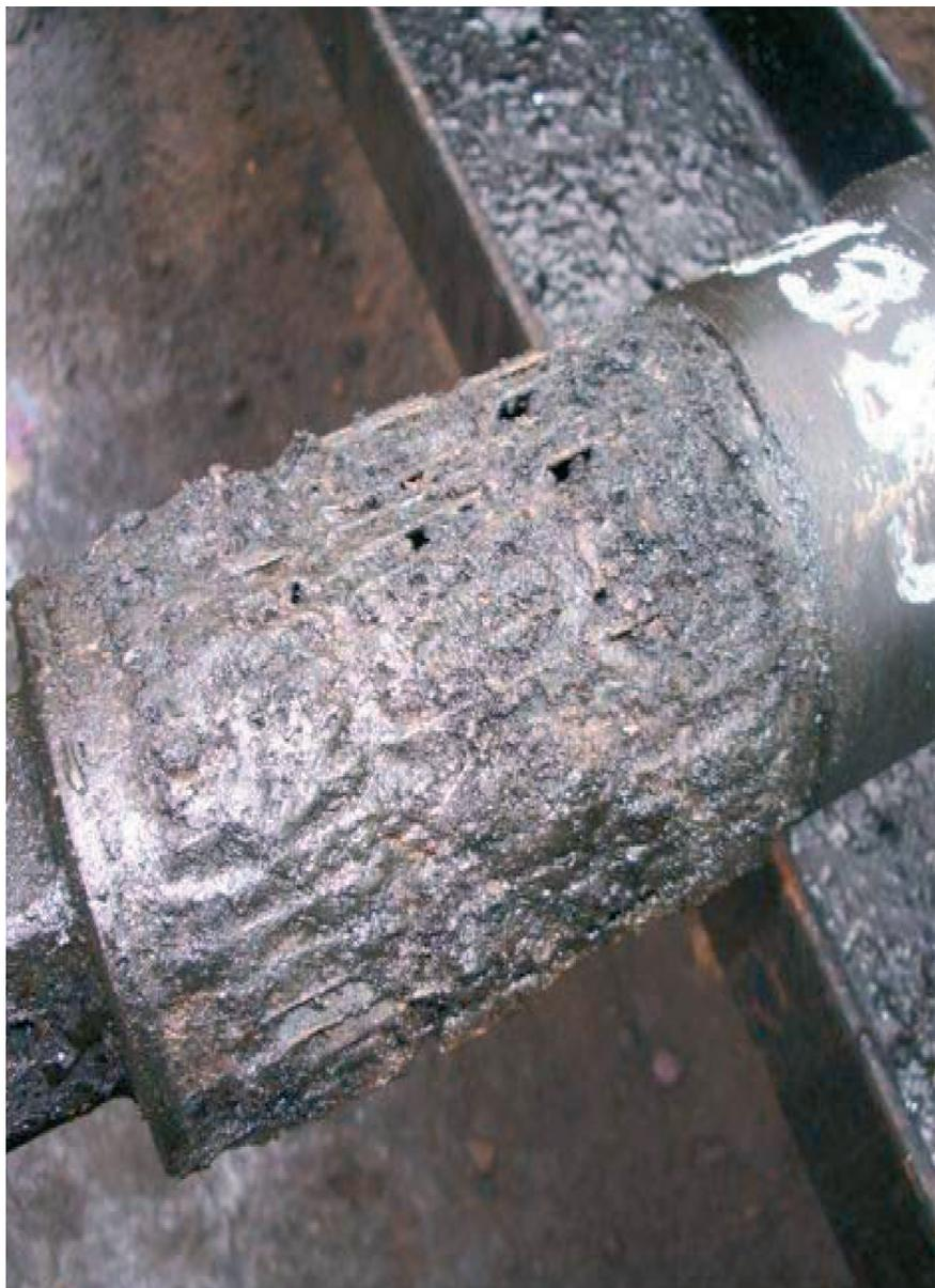
Рис. 1.1. Приемная сетка ЭЦН забита АСПО, солями и мехпри-
