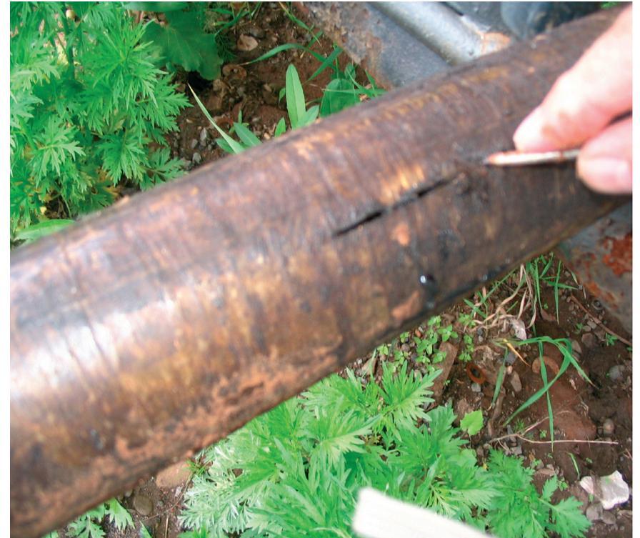
Рис. 7.17. Стеклопластиковые фильтры Бийского завода. А) Конструкция фильтра. Б) Поднятый из скважины фильтр через 1,5 года работы насоса. Нет следов коррозии и осадконакоплений. В щели застряла шкимка.
