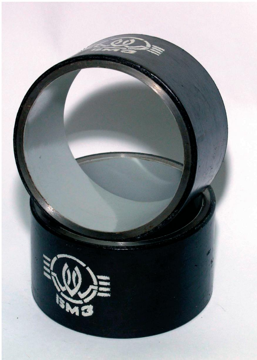
Рис. 6.9а. Внутреннее покрытие труб эпоксидной смолой.
