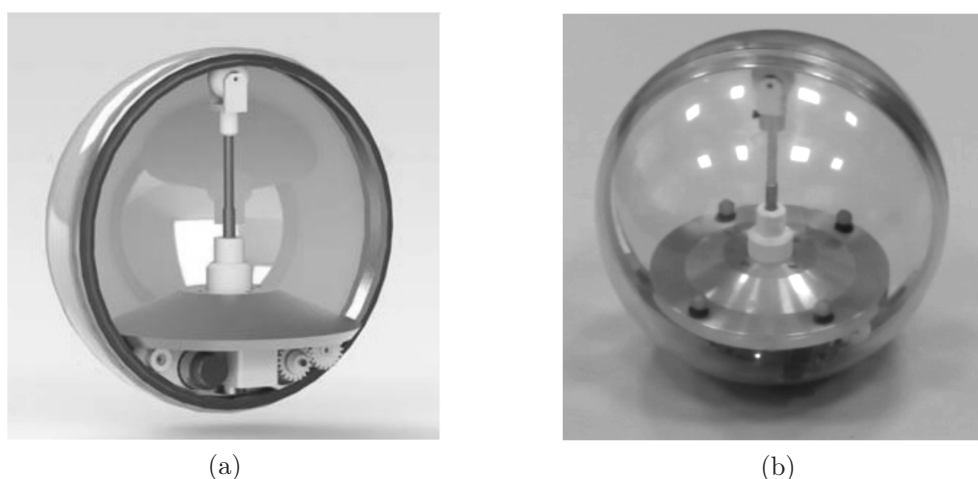
Рис. 2. (a) модель сфероробота комбинированного типа; (b) фото натурального образца.
