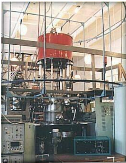
Фото 2. Рентгеноэлектронный магнитный спектрометр с технологическими приставками: копер для ударных испытаний в вакууме, напылительная приставка и манипулятор для переноса образцов без нарушения вакуума в исследовательскую камеру спектрометра.
