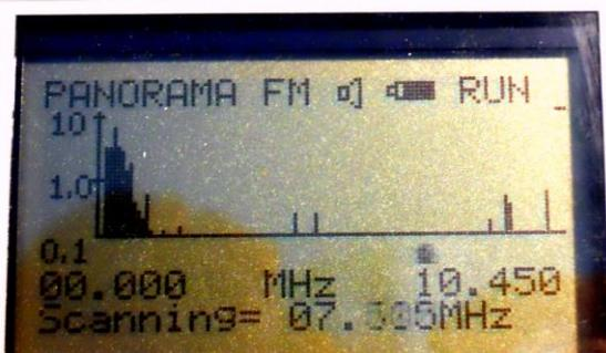
Спектрограмма фильтра «Эра» (285 руб.). К великому сожалению, фильтр «Эра» вскрыть не удалось ввиду того, что корпус фильтра был закреплен саморезами под отвертку, имеющую рабочее жало «треугольник» (крайне редкое для наших умельцев).
