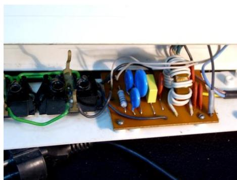
Спектрограмма фильтра Pilot-GL (Россия) и его внутреннее устройство (652 руб.)
