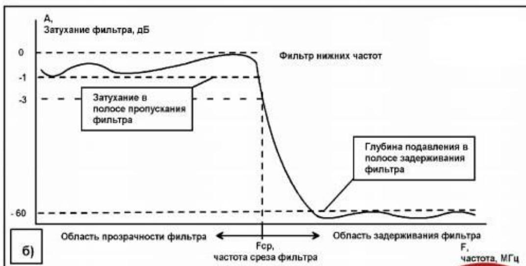
Полоса частот, которую фильтр пропускает с небольшим затуханием, называется полосой пропускания.
