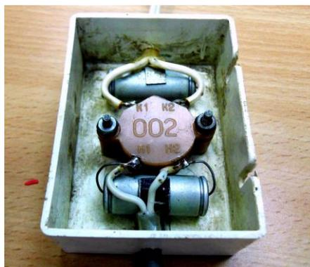
Спектрограмма самодельного фильтра и его внутреннее устройство
