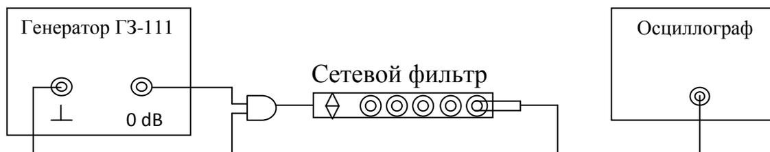
1. Подключить генератор ГЗ-111 к входу сетевого фильтра.
