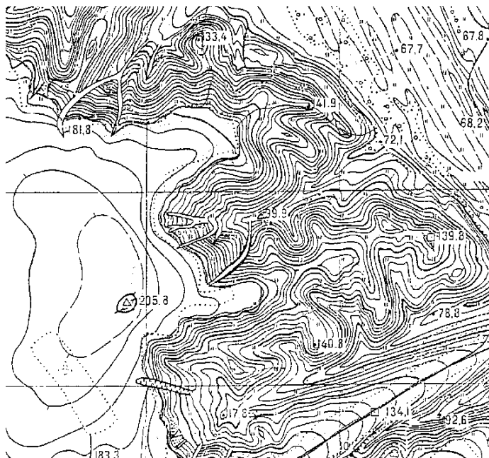
Рис.12.2. Нивальные цирки, ниши и лотки в составе нивального комплекса.
