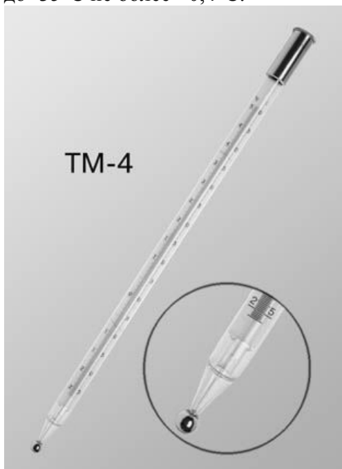
Рис. 9. А - психрометрический термометр (ТМ-4); Б – термометр-пращ (ТМ-8)
