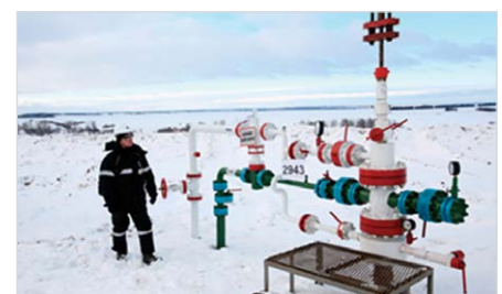
Рис. 5 — Устьевая арматура для ОРЗид
