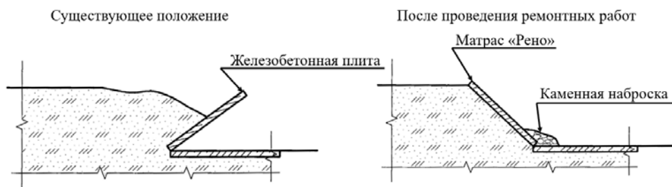
Рис. 1. Ремонт концевой части гасителя водосброса
