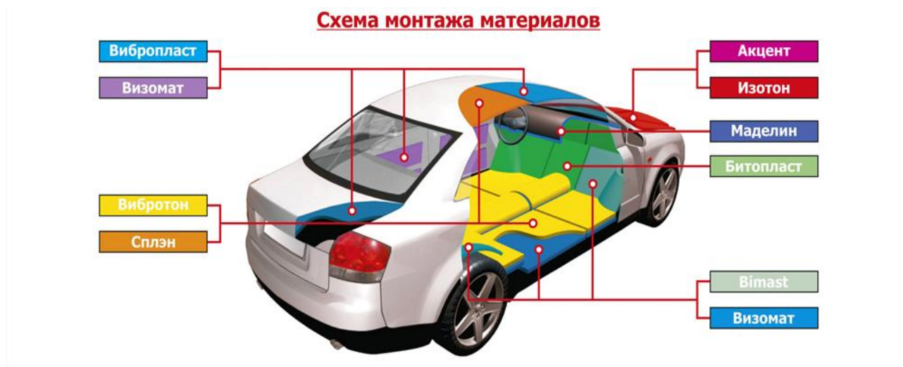
Рис. 77. Схема монтажа шумозащитных материалов
