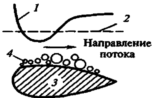
Рис. 46. Возникновение кавитационных пузырьков (4) на обтекаемом профиле (3): 1 - внешнее давление; 2 - давление насыщенных паров
