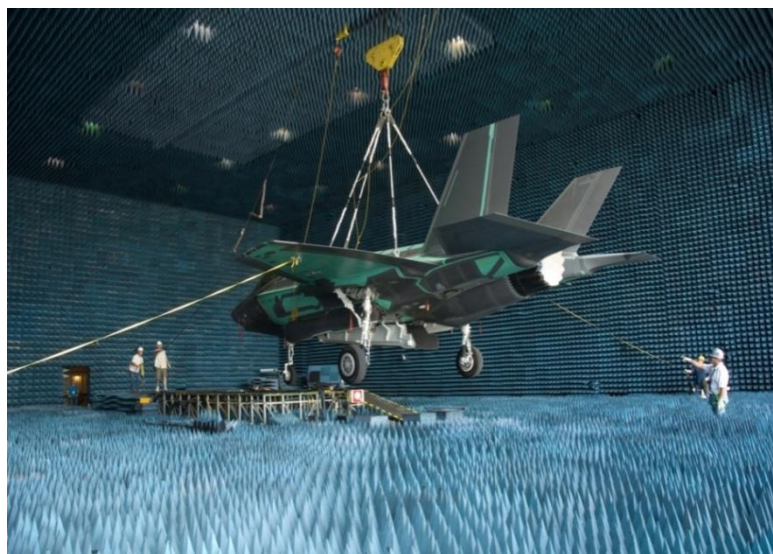
Рис. 10. Безэховая камера с акустической изоляцией
