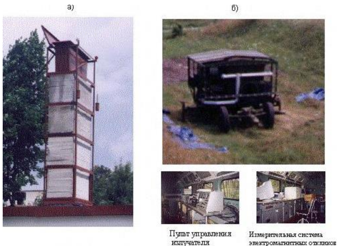
Рис. 28. Стационарный (а) и мобильный (б) акустические излучатели для проведения активных экспериментов в атмосфере
