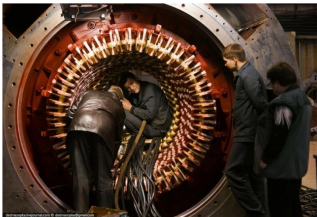
Рис. 48. Конструкция статора крупной машины с «воздушными карманами»
