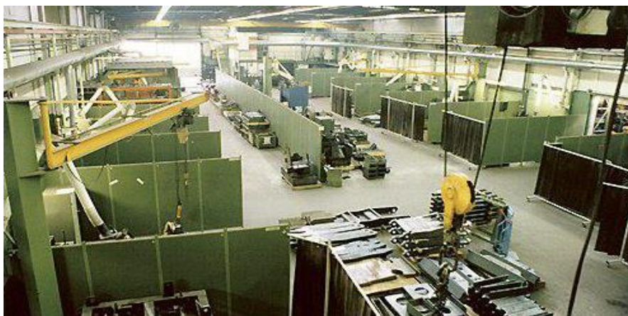
Рис. 55. Расположение акустических экранов на рабочем месте, ограничивающее распространение производственного шума
