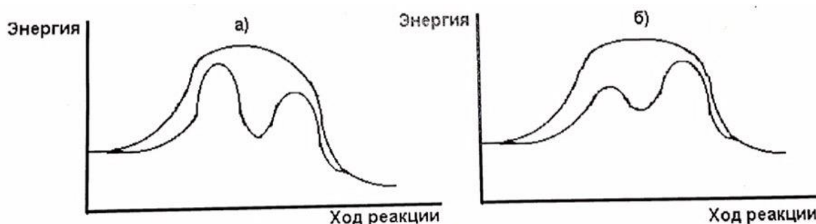
Рис.58. Энергетический профиль каталитической реакции
