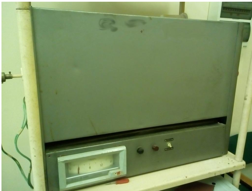
Рис. 5.1. Печь муфельная СУОЛ с возможностью установки и контроля температуры (не менее 400°C).
