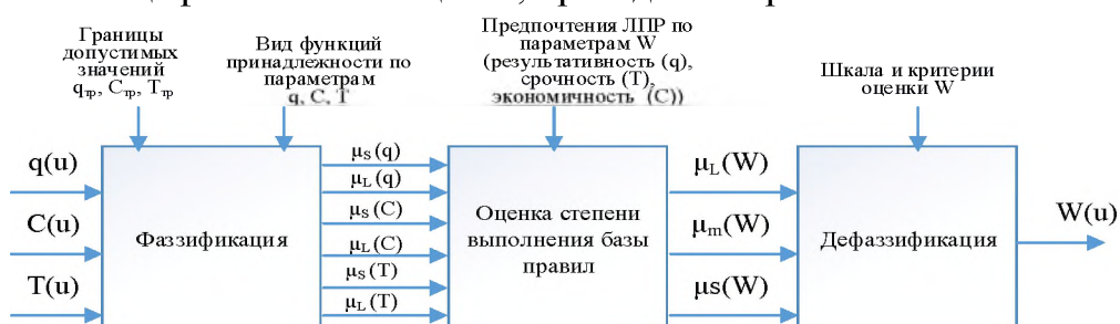
Рис. 2. Структурная схема нечеткой модели оценки эффективности ТИ [3]
