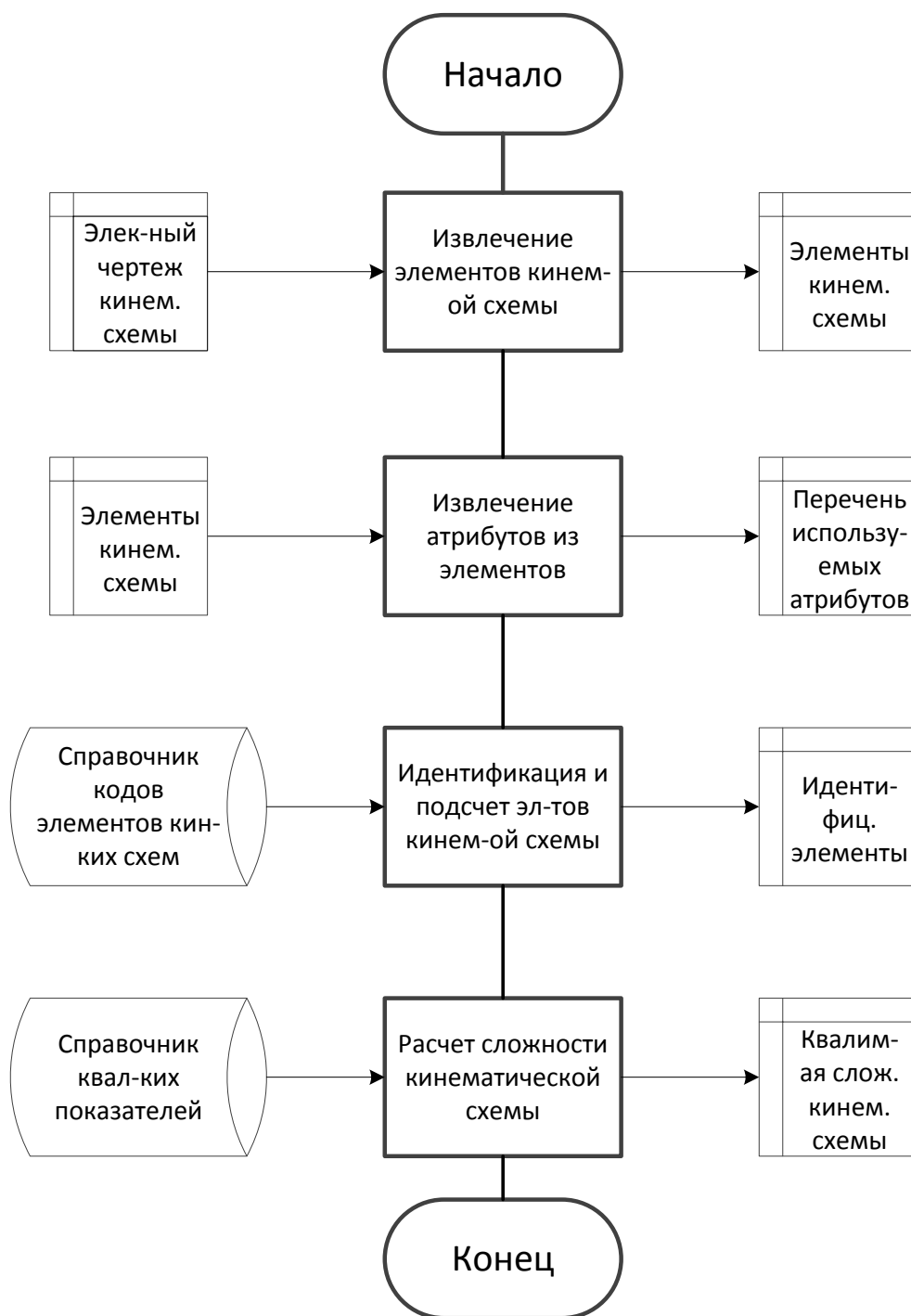
Рисунок 4.11 – Схема работы подсистемы квалиметрического анализа кинематических схем
