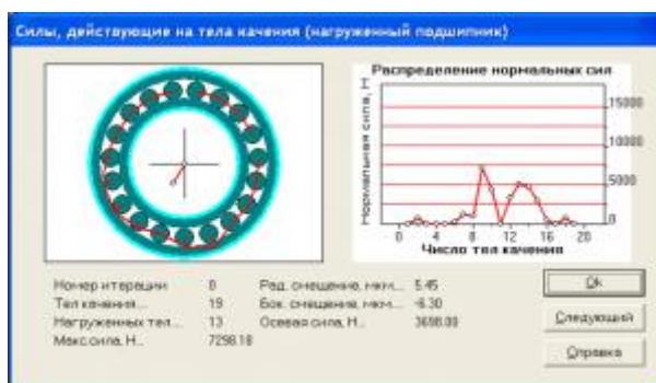
Рисунок 3.7 – Расчет подшипника в модуле APM Bear
