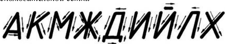
Рис. 4. Начертание прописных букв, состоящих из горизонтальных, вертикальных и наклонных элементов.
