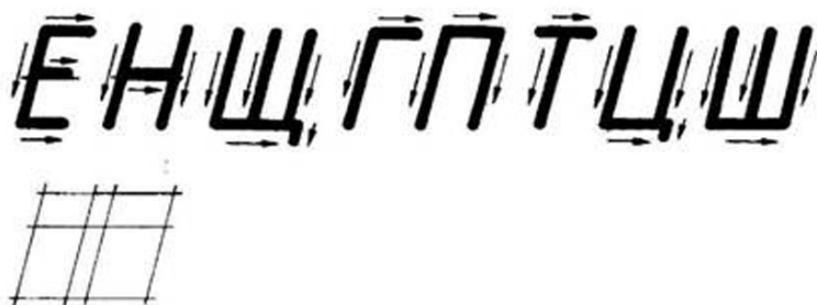
Рис. 3. Начертание прописных букв, состоящих из горизонтальных и вертикальных элементов, и построение вспомогательной сетки
