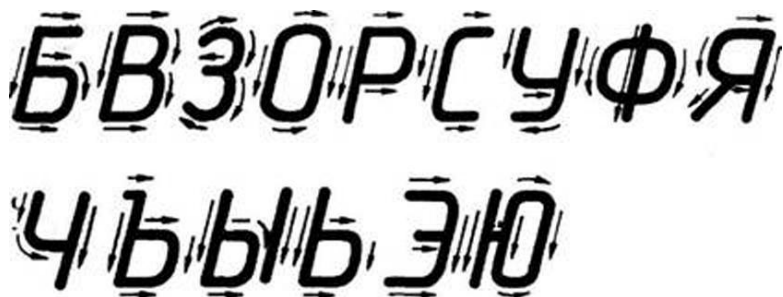
Рис. 5. Начертание прописных букв, состоящих из прямолинейных и криволинейных элементов
