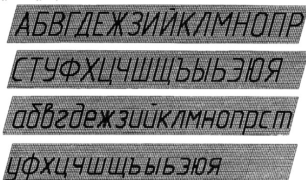
Рис. 1. Шрифты чертежные типа А.
