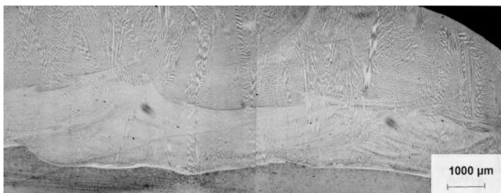
Рис. 2.13. Оптическая микроскопия образца после лазерной наплавки сплава инконель 600 [228].
