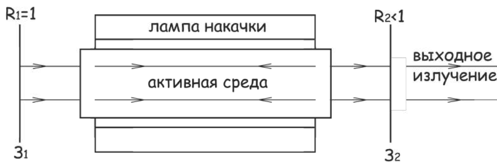
Рис. 1.5. Схематическое изображение устройства лазера
