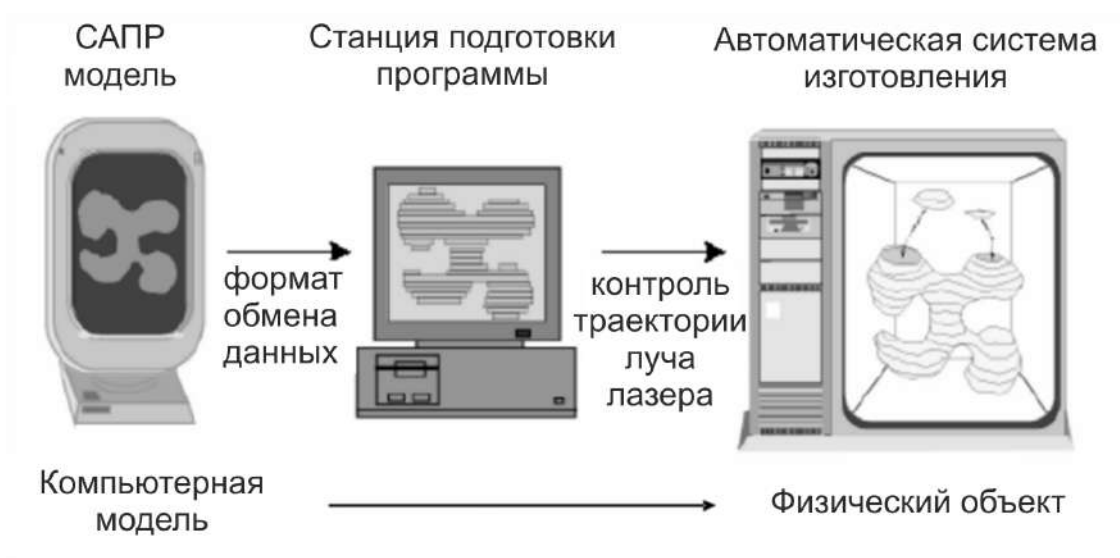
Рис. 2.1. Схема реализации БП и БИ методов [131].
