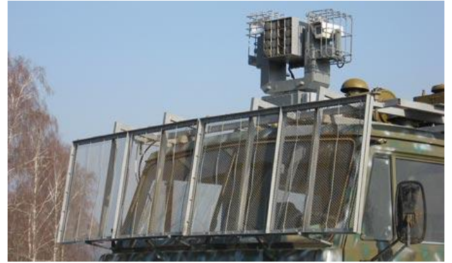
Установка отстрела спецсредств «Лафет», установленная на кузове (кабине) автомобиля
