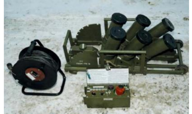
Многоразовая многоствольная пусковая установка с электрической системой запуска (ГНОМ-УМ-6)
