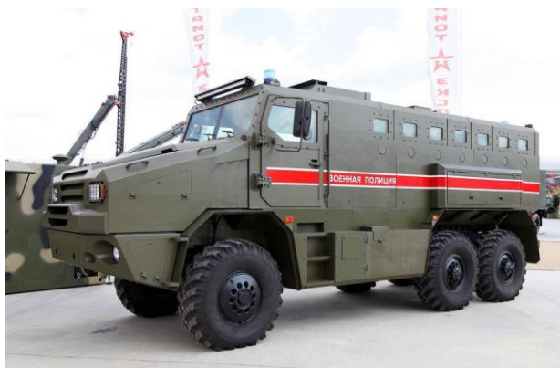
Специальный бронированный автомобиль «Федерал-М» на базе «Урал-4320»
