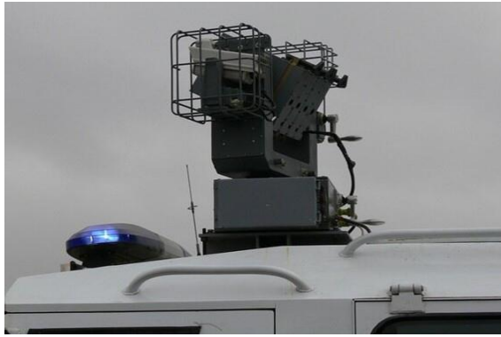
Установка отстрела спецсредств «Лафет», установленная на кузове (кабине) автомобиля
