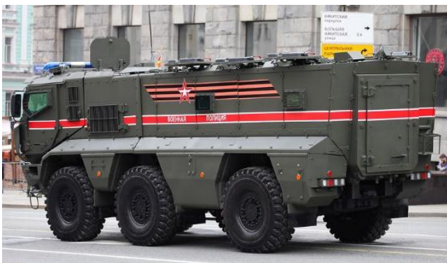
Универсальный бронированный автомобиль «Тайфун-К» на базе КамАЗ-63968
