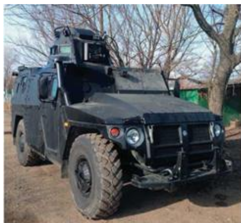
Специальная штурмовая машина спецназа ФСБ на базе СПМ-2 «Тигр» с дополнительным бронированием
