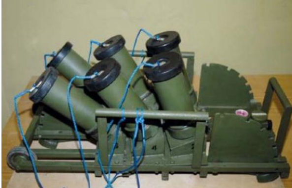
Многоразовая многоствольная пусковая установка с электрической системой запуска (ГНОМ-УМ-6)
