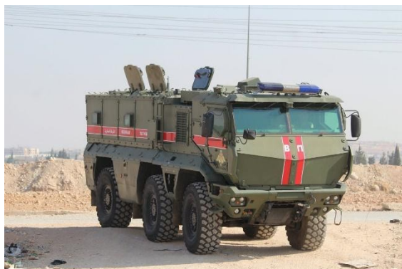
Универсальный бронированный автомобиль «Тайфун-К» на базе КамАЗ-63968
