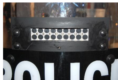
Элементы стреляющего щита «Легион» (вид стреляющего модуля на 12 и 18 зарядов и рукоятки с кнопками управления отстрелом)
