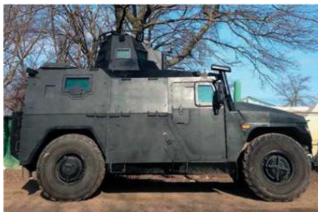
Специальная штурмовая машина спецназа ФСБ на базе СПМ-2 «Тигр» с дополнительным бронированием
