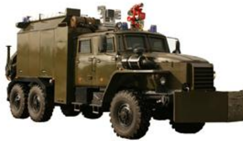
Специальная инженерная машина «Торнадо» на шасси УРАЛ-4320
