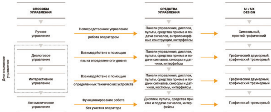
Рис. 4. Способы и средства взаимодействия потребителя и робота
