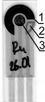
рис. 1. Планарная электродная система с модифицированным рабочим электродом: 1 – графитовый противозлектрод; 2 – электрод сравнения \text{Ag}/\text{AgCl} ; 3 – рабочий электрод, модифицированный оксидом рутения и платины.
