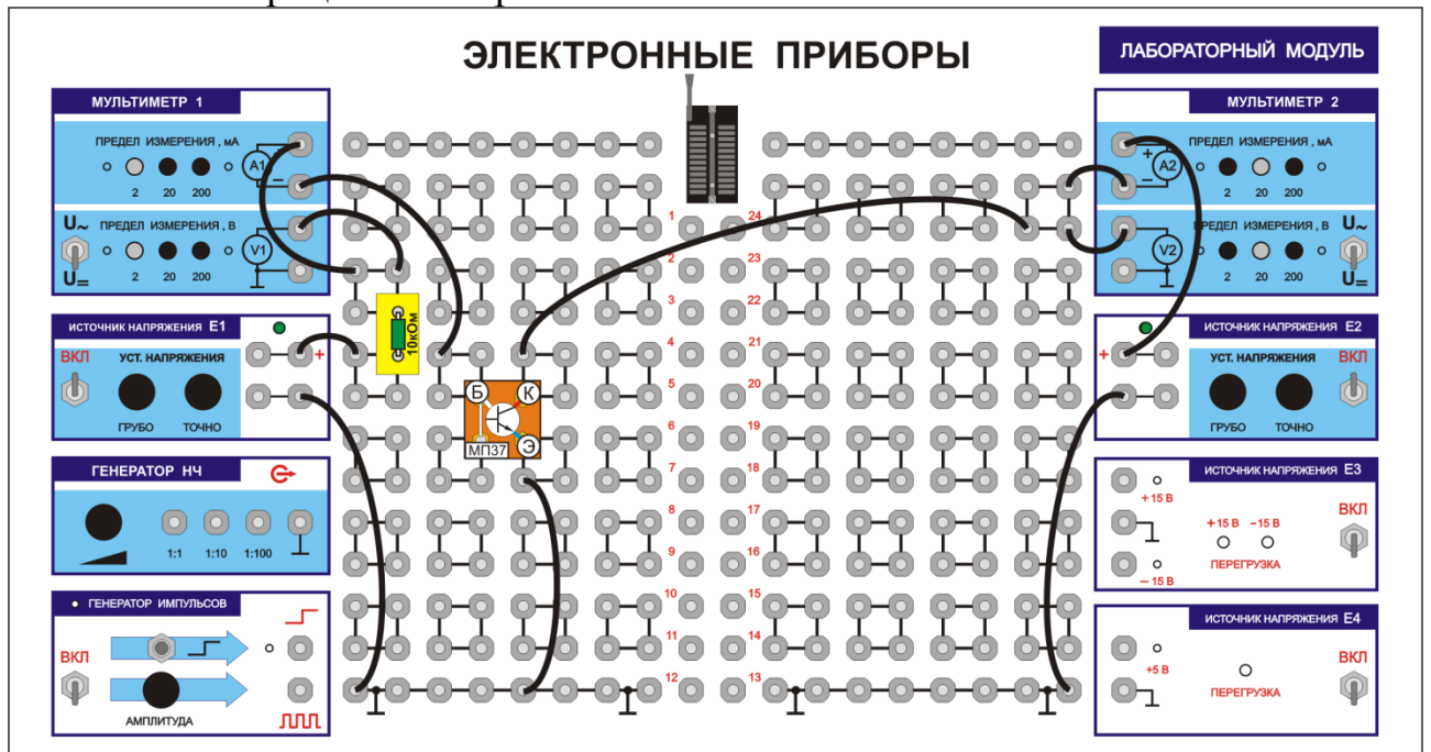
Рис 3.2. Схема соединений для снятия статических характеристик транзистора в схеме с общим эмиттером.
