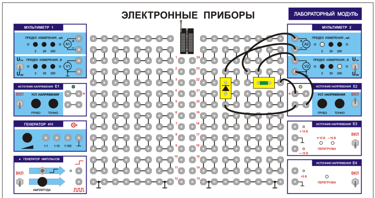
Рис.2.4. Схема соединений для снятия обратной ветви ВАХ
