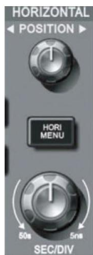
Рисунок П.5.8 – Зона управления горизонтальной разверткой на панели управления осциллографа
