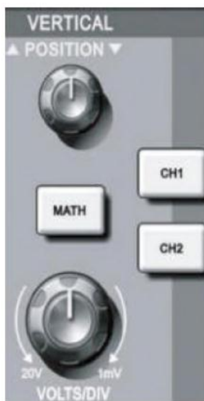
Рисунок П.5.7 – Зона управления вертикальной шкалой на панели управления осциллографа
