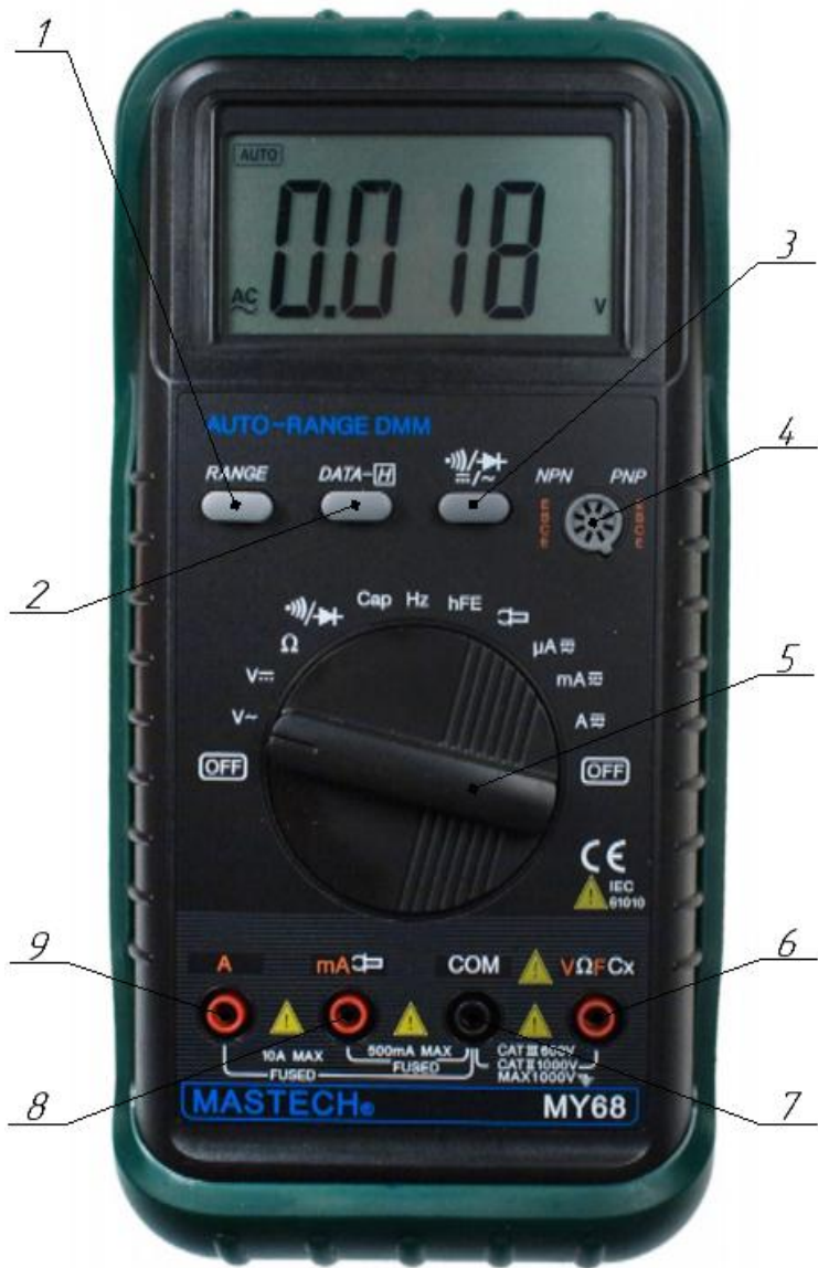
Рисунок П.1.2.1 – Устройство мультиметра Mastech MY68
