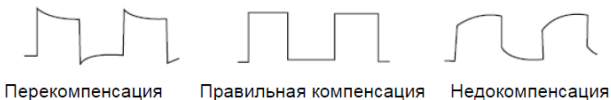
Рисунок П.5.6 – Коррекция компенсации щупов
