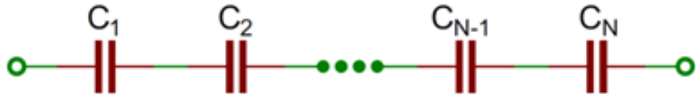
Рисунок 4.2.2 – Последовательное подключение конденсаторов
