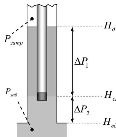
Рис. 1. – Определение забойного давления механизированной скважины
