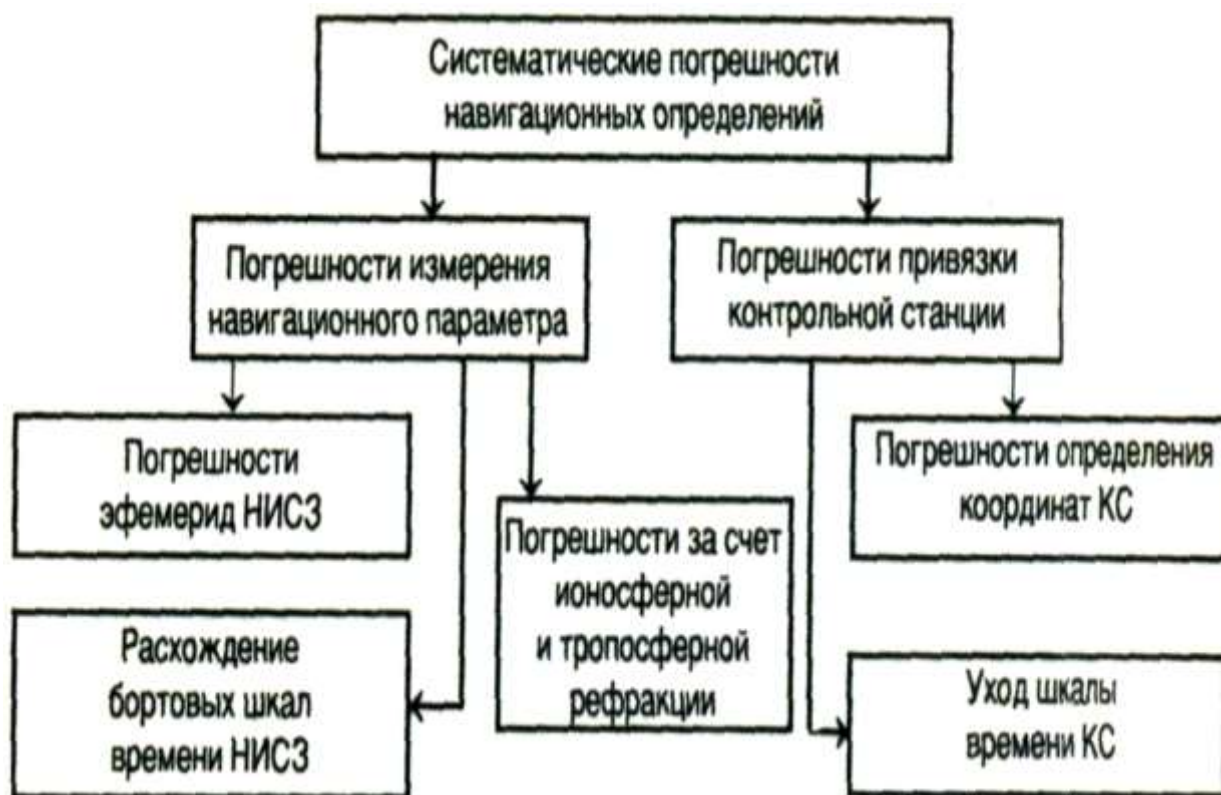
Рис.23. Систематические погрешности дифференциального режима навигационных определений
