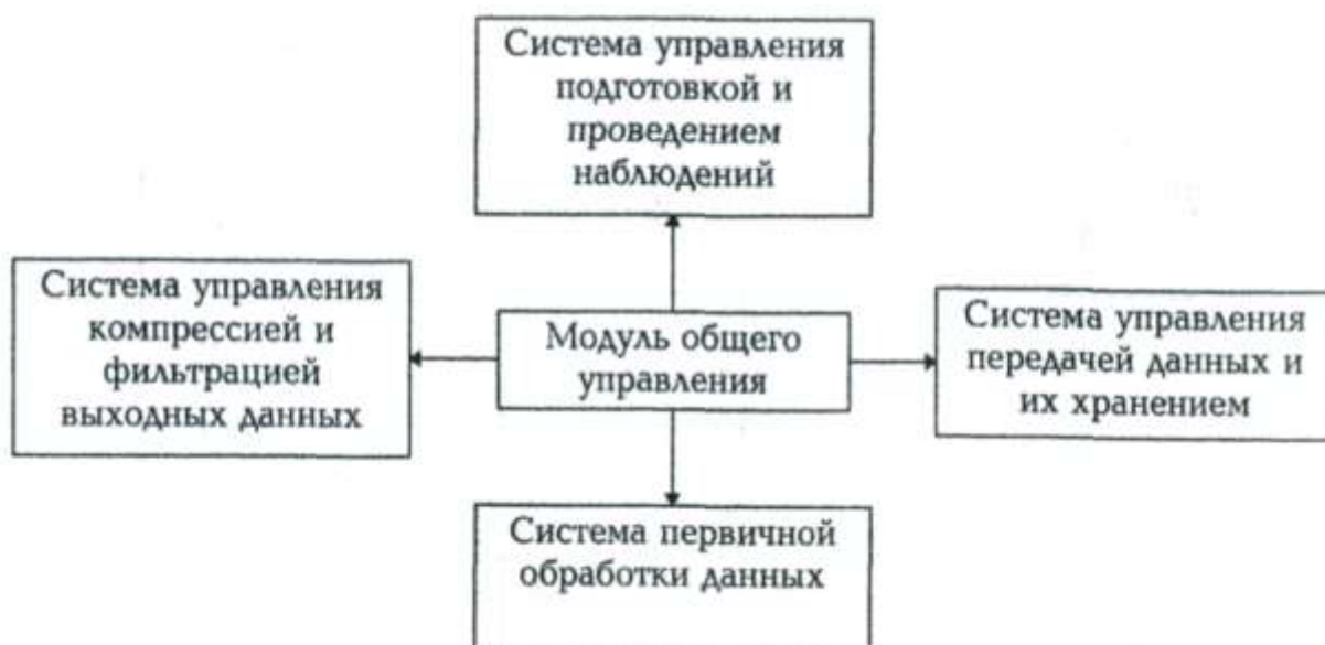
Рис. 26. Упрощенная структурная схема управленческих функций приемника
