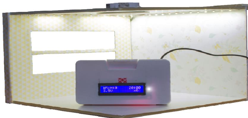
Рисунок 2 – Макет разработанного образца на основе Arduino nano
