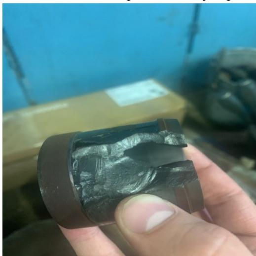
Рисунок 2 - Механический износ подшипника скольжения
