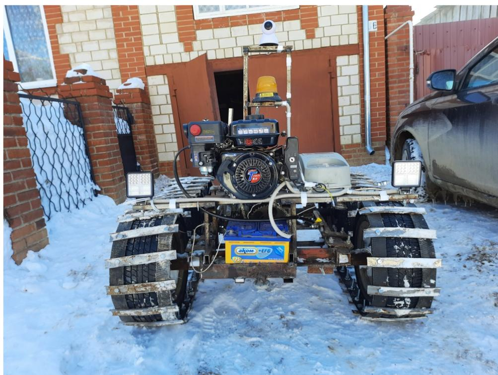
Рисунок 5 – Разработанный действующий макет трактора
