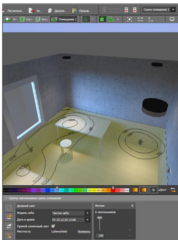
Рисунок 1 - Расчет освещенности от света из окна и от светильника
