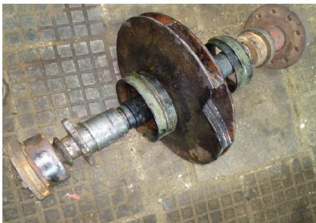
Рисунок 3 - Механический износ рабочего колеса насоса сырой воды
