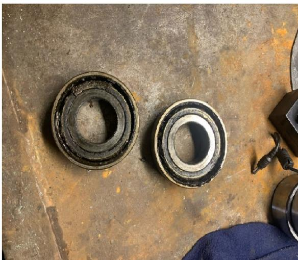
Рисунок 1- Механический износ радиально-упорных подшипников
