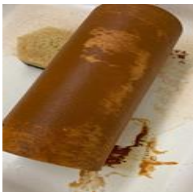
Рис. 2. Проточный фильтр, работающий в октябрьском районе г. Ижевск в течение 4 мес.
