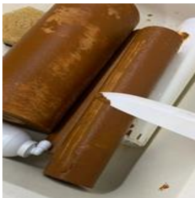
Рис. 1. Проточный фильтр, работающий в октябрьском районе г. Ижевск в течение 4 мес.
