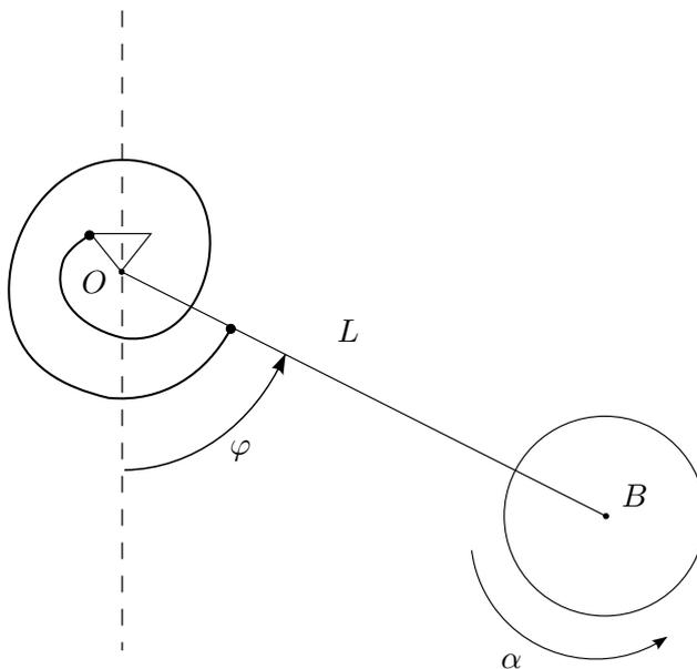
Рис. 6. Система маятника, управляемого маховиком
