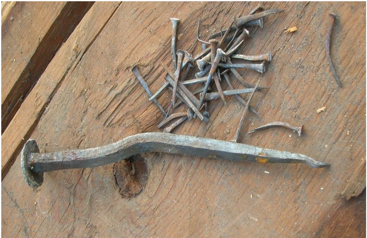
Рис. 4.24. Фото июль, 2007 г. Этим кованым гвоздям, из разобранного здания Малой Водяной Турбины, больше 100 лет [В:8].
