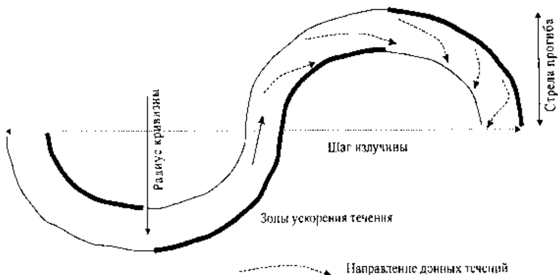
Рис. 4.4. Элементы излучин русла и распределение в их пределах скоростей и зон ускорения течения.
