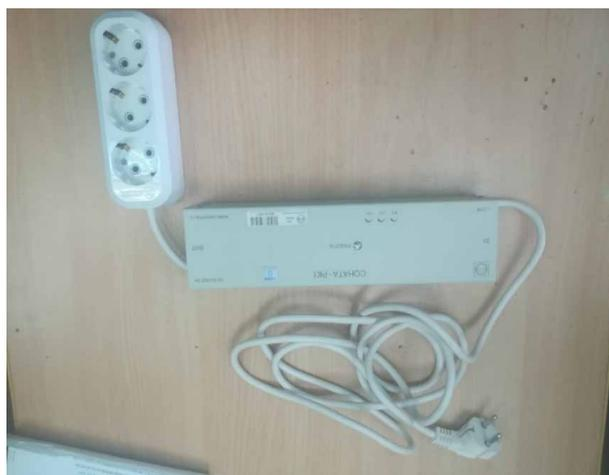
Рисунок 1 – Изображение устройства комбинированной защиты объектов информатизации «Соната-РК1»
