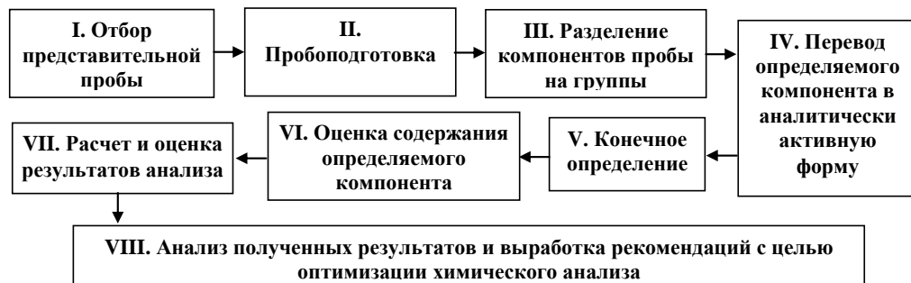
Рис. 1. Стадии химического анализа, вносящие значимый вклад в погрешность измерений
