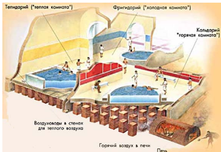
Рис. 16. Устройство римских терм
