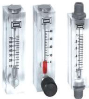
Рис. 2.51. Примеры типовых стеклянных ротаметров
