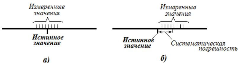
Рис. 1.4. Разброс результатов вокруг истинного значения при отсутствии (а) и при наличии (б) систематической погрешности
