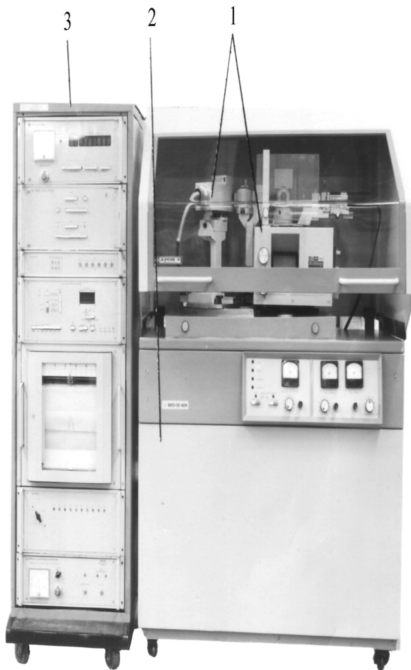
Рис. 1.5. Аппарат рентгеновский ДРОН-3.0: 1- стойка дифрактометрическая с гониометром ГУР-8, рентгеновской трубкой и детектором; 2 – источник питания высоковольтный; 3 – устройство электронно-вычислительное унифицированное
