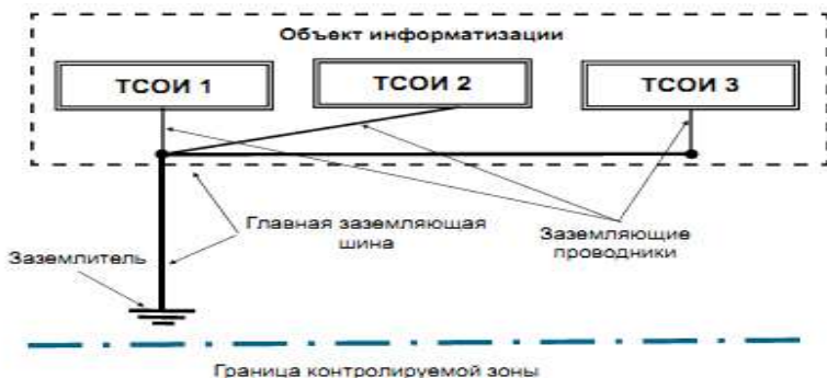
Рис. 3. Одноточечная комбинированная схема заземления
