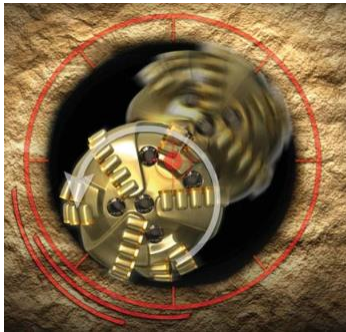
Рисунок 3. Непрерывное вращение КНБК в процессе бурения при полноценном пространственном контроле
