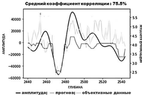
Рис. 4. Пример синтезирования кривой нейронного каротажа
