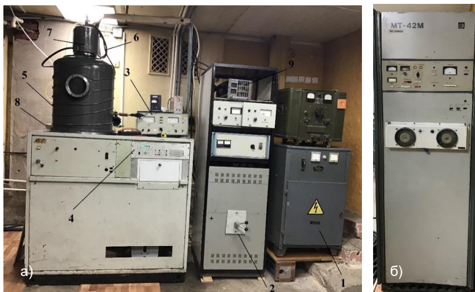
Рисунок 1. Установка вакуумного азотирования (а) и импульсный источник питания (800 В, 0-30 Гц) (б): 1 - Источник питания разряда (50 В, 40 А); 2 – Источник питания накала спиралей ионного источника (90 А, 15 В); 3 – Вакууметры ВИТ-3, ВМБ-14, ВТЗ; 4 – Блок управления откачки АВ2107; 5 – Рабочая вакуумная камера; 6 – Система охлаждения установки; 7 – Соленоид ионного источника; 8 – Натекатель ручной; 9 – Источник питания соленоида ионного источника.
