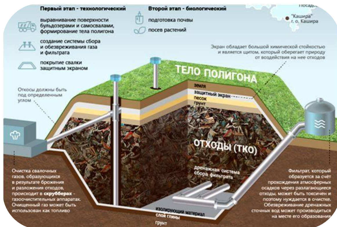
Рисунок 7. Конструкция полигона
