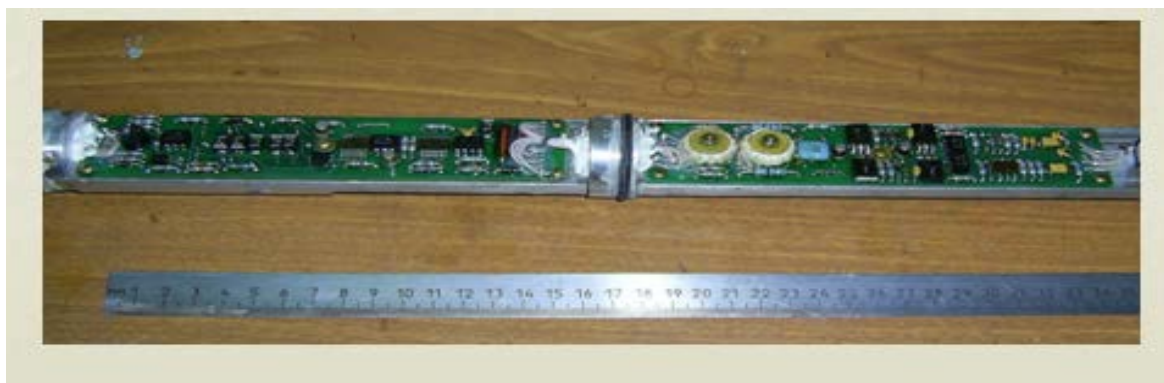
Рис. 3 Телесистема с гидравлически каналом связи с двумя трёхосными ортами акселерометров и ортом феррозондовых магнитометров.
