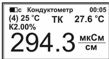
Показания УЭП будут приведены к заданной температуре (по умолчанию, к 25°C с температурным коэффициентом  $K = 2,00\%$ , о чем свидетельствуют значения температуры приведения «25°C» и температурного коэффициента «K2.00%», проставленные рядом с номером поддиапазона). При повторном нажатии кнопки «ТК» прибор вернется в обычный режим измерения без приведения к заданной температуре.
