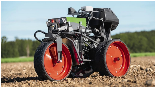
Рисунок 6 – Роевый робот точного посева Fendt Xaver
