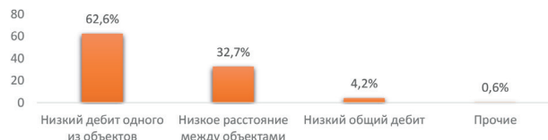
Рис. 2. Причины отсутствия возможности спуска компоновки ОРЭ
