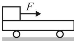
2.21 Тележка массой  $M$  может без трения катиться по горизонтальной поверхности. У заднего края тележки лежит брусок массой  $m$  (см. рис.). Коэффициент трения между бруском и тележкой  $\mu$ . К бруску приложена горизонтальная сила  $F$ , достаточная для того, чтобы брусок начал двигаться относительно тележки. Через какое время брусок упадет с тележки, если ее длина  $l$ ? При какой минимальной силе  $F_0$  брусок начнет скользить?
