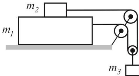
2.41 Через систему блоков, изображенную на рисунке, перекинута нить. К подвижному блоку подвешен груз массой  $M = m_1 + m_2$ . При каком соотношении между массами  $m_1$  и  $m_2$  бруски не будут скользить друг по другу, если коэффициент трения между брусками равен  $\mu$ , а коэффициент трения о плоскость равен нулю? Нить невесома и нерастяжима, массой блоков и трением в них пренебречь.
