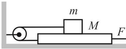
2.23 В системе, изображенной на рисунке, массы брусков  $M = 2$  кг,  $m = 1$  кг. Какую силу нужно приложить к нижнему бруску, чтобы он двигался с постоянным ускорением  $a = g/2$ ? Коэффициент трения между брусками  $\mu = 0,5$ ; между столом и нижним бруском  $\mu_2 = 0,2$ .
