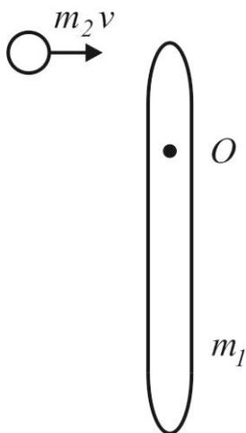
4.21 Однородный тонкий стержень массой  $m_1 = 0,2$  кг и длиной  $L = 0,2$  м может свободно вращаться вокруг горизонтальной оси, проходящей через точку  $O$ . В верхний конец стержня попадает пластилиновый шарик массой  $m_2 = 10$  г, движущийся со скоростью  $v = 10$  м/с, и прилипает к стержню. Определить угловую скорость стержня и линейную скорость нижнего конца стержня сразу после удара, если расстояние от верхнего конца до точки  $O$  равно  $a = L/3$ .
