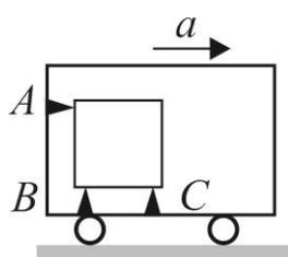
1 Однородный куб массой  $m = 10,0$  кг лежит в углу вагона на трех опорах  $A, B, C$  (рис. ). Определить силы реакции опор  $F_a, F_b, F_c$ , если известно, что вагон движется с ускорением  $a = 2,00$  м/с<sup>2</sup>.
