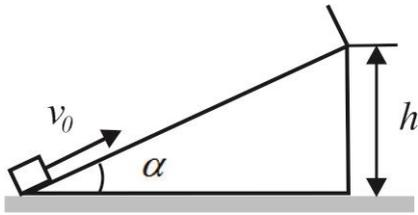
3.18 Тело начинает двигаться вверх по наклонной плоскости со скоростью  $V_0=10$  м/с. На высоте  $H=1$  м оно упруго ударяется о преграду. Определить скорость тела в момент, когда оно вновь окажется у основания наклонной плоскости. Угол наклона плоскости к горизонту  $\alpha=30^\circ$ , коэффициент трения  $\mu=0,3$ .
