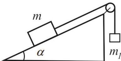
4.16 На наклонной плоскости с углом наклона  $\alpha$  лежит брусок массой  $m$ . Груз массой  $m_1$  присоединен к бруску при помощи нити, перекинутой через блок в виде цилиндра радиуса  $R$  и массой  $M$ . Определить натяжения нити, если коэффициент трения бруска о плоскость  $\mu$ . Массой нити пренебречь.
