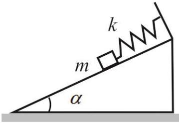
3,36 На наклонной плоскости лежит брусок, соединенный пружиной с неподвижной опорой. Из положения, когда пружина не деформирована, брусок без начальной скорости отпускают, и он начинает скользить вниз. Определить максимальное растяжение пружины. Масса бруска  $m=0,5$  кг, жесткость пружины  $k=120$  Н/м, угол наклона плоскости к горизонту  $\alpha=45^\circ$ , коэффициент трения бруска о плоскость  $\mu=0,5$ .
