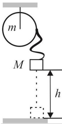
4\* Маховик, имеющий вид диска радиуса  $R$  и массой  $m$  может вращаться вокруг горизонтальной оси. К его цилиндрической поверхности прикреплен шнур к другому концу которого подвешен груз массы  $M$ . Груз был приподнят, а затем опущен. Упав свободно с высоты  $h$ , груз натянул шнур, и благодаря этому привел маховик во вращение. Какую угловую скорость приобрел при этом маховик?
