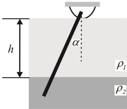
4.13 Тонкая однородная палочка шарнирно укреплена за верхний конец. Нижняя часть палочки погружена в воду. Равновесие достигается, когда палочка расположена наклонно и погружена в воду на половину своей длины. Какова плотность материала, из которого сделана палочка?
