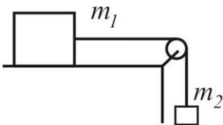
4.15 Два тела массой  $m_1$  и  $m_2$  соединены нерастяжимой нитью перекинутой через блок в виде цилиндра радиуса  $R$  и массой  $M$ . Коэффициент трения между грузом и столом  $\mu$ . Определить ускорения грузов.
