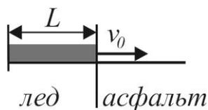
3 Санки, движущиеся по горизонтальному льду со скоростью  $v = 2$  м/с, въезжают на асфальт. Считая, что длина полозьев санок равна  $L = 0,8$  м, а коэффициент трения их об асфальт равен  $\mu = 0,2$ , определить путь  $S$ , пройденный санками по асфальту, если известно, что  $S > L$ . Массу санок считать равномерно распределенной по длине полозьев. Трением санок о лед пренебречь.
