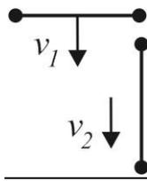
2\* По горизонтальной поверхности скользят две одинаковые гантели, расположенные как показано на рисунке. Скорости их соответственно равны  $v_1$  и  $v_2$ . Каждая гантель представляет собой невесомый жесткий стержень длиной  $L$ , на концах которого укреплены две одинаковые точечные массы. Определить характер движения каждой из гантелей после удара. Удар считать абсолютно упругим.
