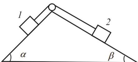
4.17 Найти ускорение, с которым движутся грузы. Масса грузов одинакова  $m_1 = m_2 = 1 \text{ кг}$ , угол  $\alpha = 30^\circ$ , угол  $\beta = 45^\circ$ . Коэффициент трения грузов 1 и 2 о наклонные плоскости  $\mu = 0,4$ . Принять блок за цилиндр радиуса  $R$  и массой  $M$ .
