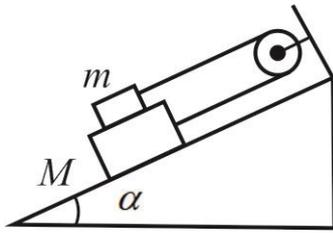
2.22 На наклонной плоскости с углом при основании  $\alpha$  находится доска массой  $M$  и на ней брусок массой  $m$  ( $M > m$ ) (см. рис.). Коэффициент трения между доской и плоскостью  $\mu$ , между доской и бруском  $2\mu$ . Определить ускорение этих тел. При каком отношении масс тела будут находиться в равновесии? Нить невесома и нерастяжима.
