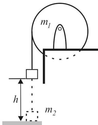
4.27 Маховик, имеющий форму диска массой  $m_1 = 48 \text{ кг}$  и радиусом  $R = 0,4 \text{ м}$ , может вращаться вокруг горизонтальной оси. К концу нити, намотанной на маховик, прикреплен груз массой  $m = 0,2 \text{ кг}$ , который удерживается на высоте  $h = 0,2 \text{ м}$  от пола. Какую максимальную угловую скорость приобретет маховик, если груз отпустить?
