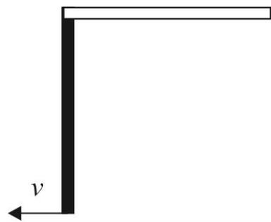
1 Тонкий однородный стержень длиной  $L$  может вращаться вокруг горизонтальной оси, проходящей через конец стержня перпендикулярно ему. Стержень отклонили на угол равный  $90^\circ$  от положения равновесия и отпустил. Определить скорость нижнего конца стержня в момент прохождения положения равновесия.
