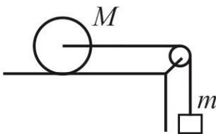
5 На сплошной цилиндр, который может кататься по горизонтальной плоскости без проскальзывания, намотана нить. Нить перекинута через блок и к концу ее привязан груз. Считая массы всех тел и моменты инерции круглых тел известными, найти ускорение подвешенного груза. Массой нити и трением в блоке пренебречь, нить нерастяжима и по блоку не проскальзывает.
