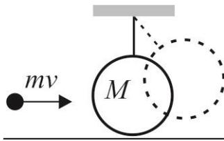
1 Маятник в виде однородного шара, жёстко скреплённого с тонким стержнем, длина  $l$  которого равна радиусу  $R$  шара, может качаться вокруг горизонтальной оси, проходящей через конец стержня. В шар нормально к его поверхности ударились пуля массой  $m=10$  г, летевшая со скоростью  $V = 800$  м/с, и застряла в шаре. Масса шара  $M = 10$  кг, радиус его  $R = 15$  см. На какой угол  $\alpha$  отклонится маятник в результате удара пули? Массой стержня пренебречь.
