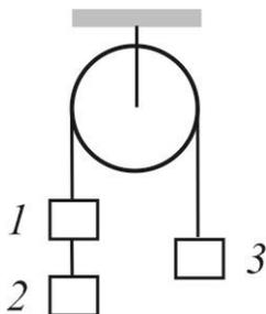
4.19 Через неподвижный блок в виде цилиндра перекинута нить, к которой подвешены три одинаковых груза массой  $m$  каждый. Какой путь пройдут грузы за первые  $t$  секунд движения? Нити невесомы, нерастяжимы. Масса блока  $M$ .
