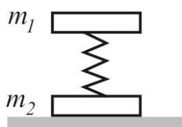
4 Две пластины, массы которых равны  $m_1$  и  $m_2$ , скреплены между собой пружиной. С какой силой  $F$  нужно давить на верхнюю пластину, чтобы, двигаясь вверх после прекращения действия силы, верхняя пластина приподняла нижнюю?
