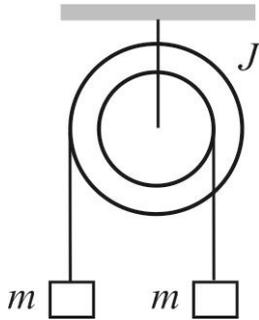
4\* На ступенчатый вал, радиусы которого  $R = 0,3$  м  $r = 0,1$  м намотаны в противоположных направлениях невесомае нерастяжимые нити. К концам нитей привязаны грузы массой  $m = 1$  кг каждый. Момент инерции вала  $J = 0,3$  кгм<sup>2</sup>. Найти ускорен грузов.
