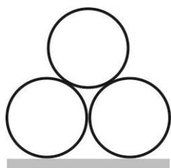
3 На земле лежат вплотную друг к другу два одинаковых бревна цилиндрической формы. Сверху кладут такое же бревно. При каком коэффициенте трения  $\mu$  между бревнами они не раскатятся? По земле бревна не скользят.
