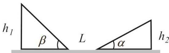
3.17 Санки съезжают с ледяной горки уклоном  $\alpha$  с высоты  $h_1$  и по инерции въезжают на противоположенный склон уклоном  $\beta$  на высоту  $h_2$ . Путь, пройденный санками по горизонтали равен  $L$ . Найдите коэффициент трения санок о лед.
