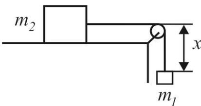
2.15 Два груза соединены весомой нерастяжимой однородной нитью длиной  $l$  так, как показано на рисунке. Массы грузов  $m_1 = m$ ,  $m_2 = 2/3 m$ , нити  $m_3 = 1/3 m$ . При какой длине вертикального отрезка нити  $x$  силы, действующие на грузы со стороны нити, окажутся равными? Чему равны эти силы? Каково ускорение системы в этом случае? Трения в системе нет. Нить невесома и нерастяжима.
