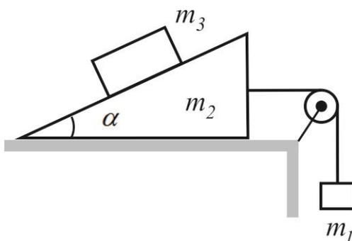
2.42 Определить ускорения тел  $m_1$ ,  $m_2$ ,  $m_3$  в механической системе, изображенной на рисунке. Наклонная плоскость при основании имеет угол  $\alpha$ . Трением, массой блока и нити пренебречь. Нить невесома и нерастяжима.
