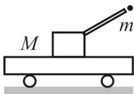
1 На железнодорожной платформе, движущейся со скоростью  $v=5$  м/с укреплено орудие (см. рис). Масса платформы с орудием  $M=104$  кг орудия, ствол которого приподнят над горизонтом на угол  $\alpha=60^\circ$ , производится выстрел. Масса снаряда  $m=25$  кг, начальная скорость снаряда относительно орудия  $u=500$  м/с. Определить скорость платформы, если ствол орудия направлен, в сторону движения и против движения платформы.
