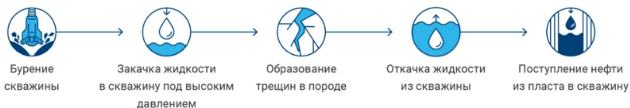
Рис. 3. Схема проведения ГРП в скважине [3].
