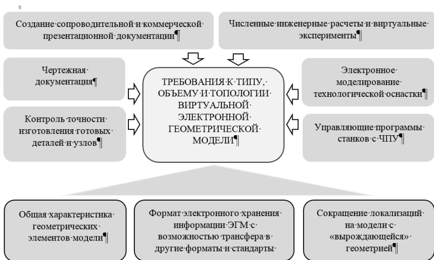
Рис. 1. Схема требований к ЭГМ при проектировании и производстве НТТМ
