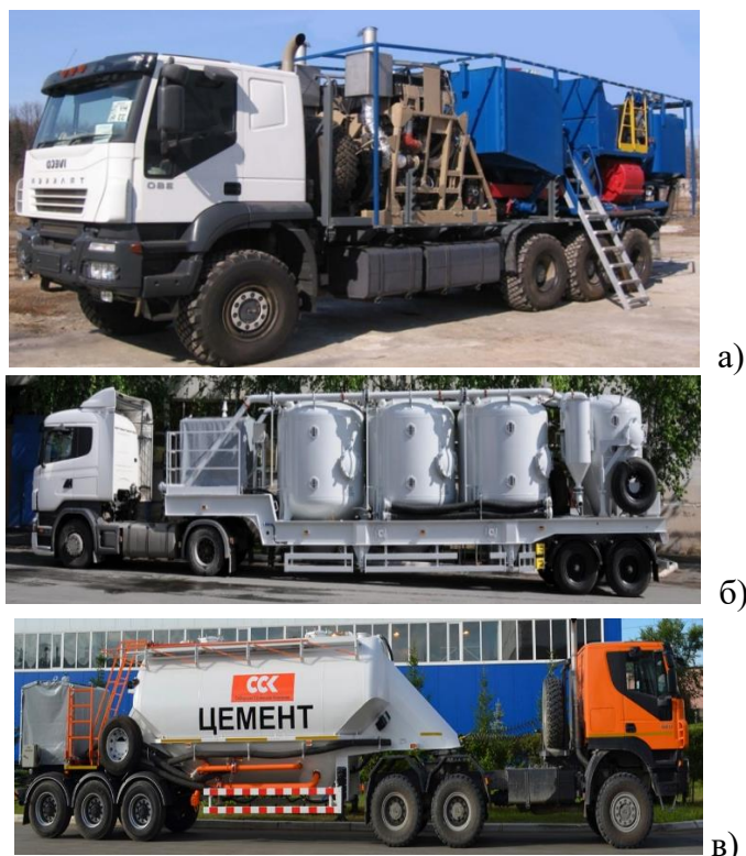
Рис. 3. Смоделированная компоновка по технология умного производства Manufacturing Execution System MES а) установка насосная УНБС2-600x70, б) мобильный цементный склад ЦТ 40, в) цементовоз ЦТ-25
