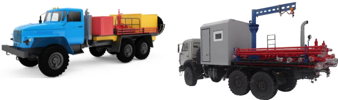
Рис. 1. На шасси грузовиков КАМАЗ или УРАЛ установлен а) цементировочный агрегат ЦА-320, б) блок манифольдов БМ-700
