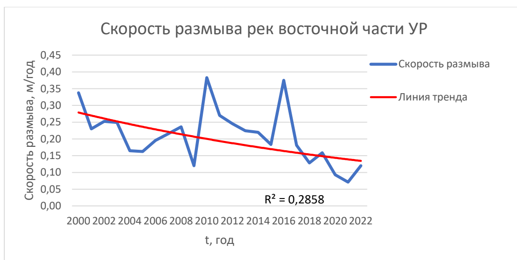
Рисунок 3. График изменения средней скорости размыва берегов на реках восточной части Удмуртии за период 2000-2022 гг., составлено автором
