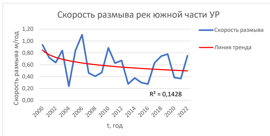
Рисунок 4. График изменения средней скорости размыва берегов на реках южной части Удмуртии за период 2000-2022 гг., составлено автором
